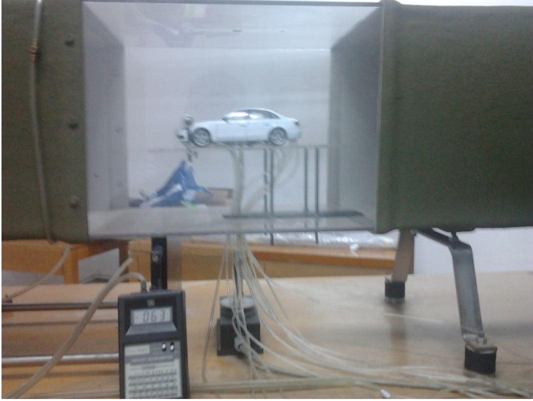
Resim 2. 3. Basınç ölçümü için hortumların modele bağlantısı
