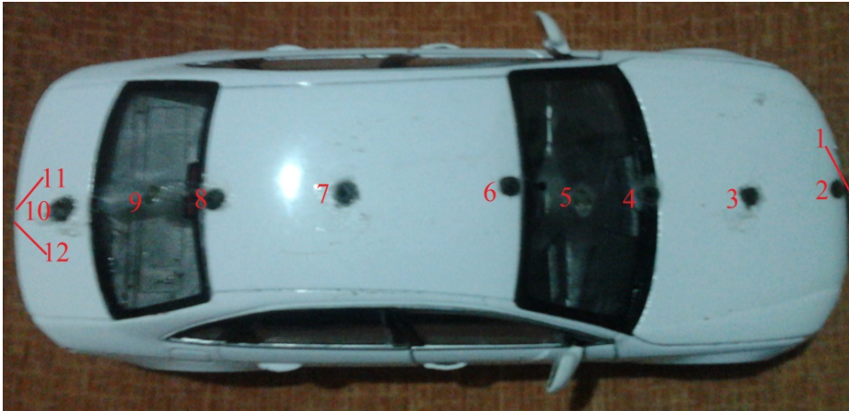
Resim 2. 2. Basınç ölçümü için model üzerine açılan delikler
