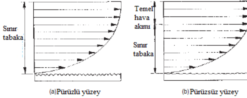
Şekil 1.14. Yüzey pürüzlülüğünün sınır tabaka üzerindeki etkisi [20].
