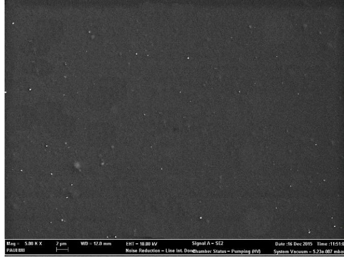
Şekil 7.9 ITO kaplı cam elektrot yüzeyinde CH için SEM görüntüsü (5000 x)
