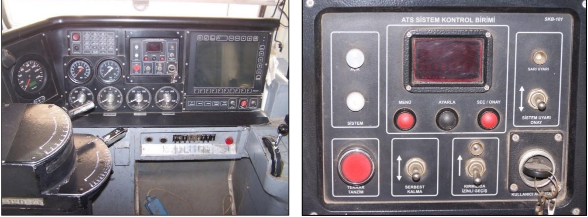
Şekil 2.2. Örnek bir ATS kontrol cihazı ve kumanda paneli
