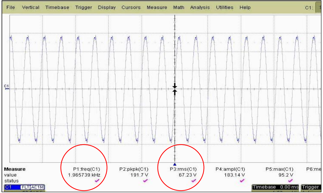
Şekil 5.16. Yol magneti 1000 Hz konumunda iken C-D noktalarından ölçülen 2000 Hz sinyali
