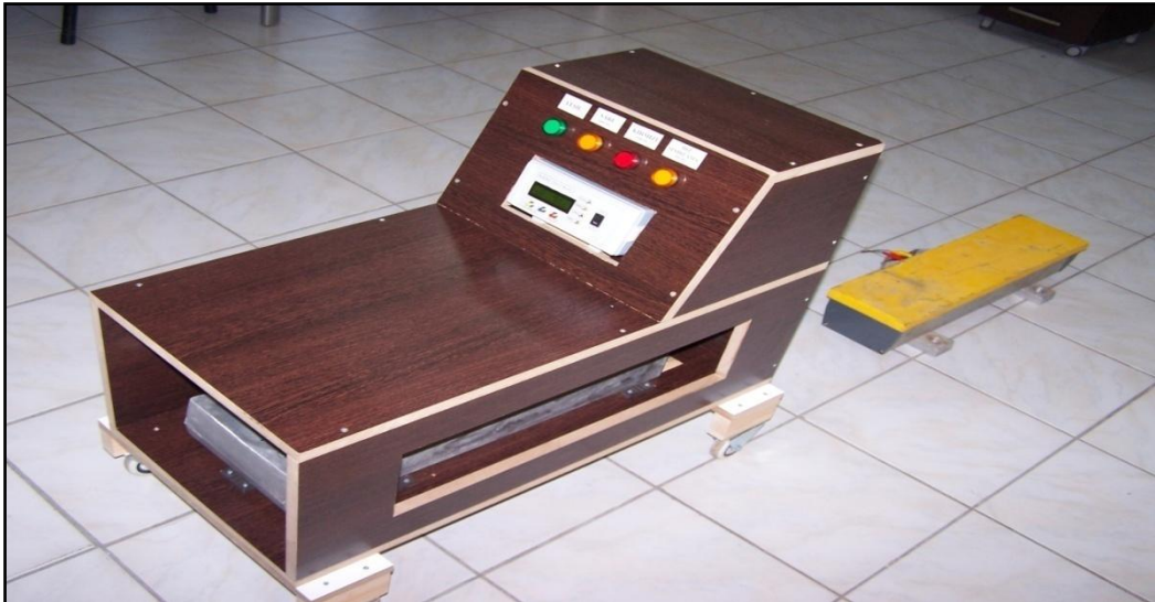
Şekil 5.21. Magnet Test Cihazı hareketli deneme kabini
