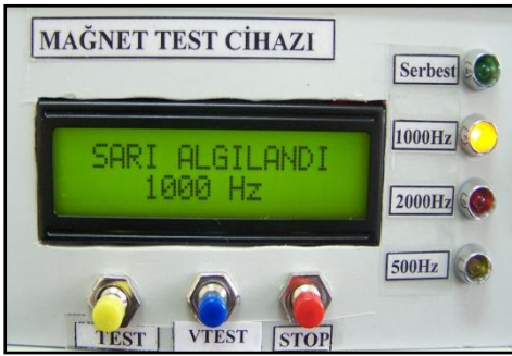
Şekil 4.5. Magnet Test Cihazının çalışma esnasındaki ekran görüntüleri
