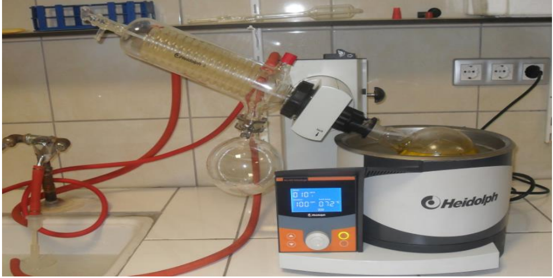
Şekil 3.3. Yağın ve biyodizelin içeriğindeki olası nemin uzaklaştırıldığı buharlaştırma işlemi
