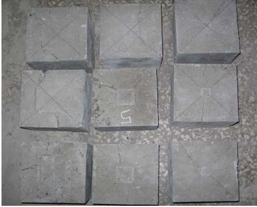
Şekil 4.5 L5 deney numunelerinin göçme şekilleri
