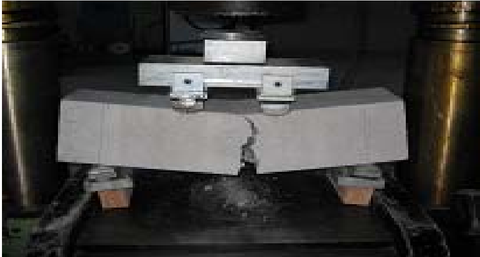
Şekil 4.8 Eğilme-çekme deneyinde numunenin kırılışı
