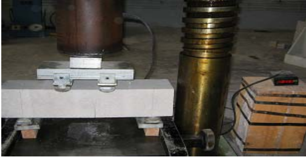
Şekil 4.7 Lifli ve lifsiz betonlar üzerinde yapılan dört noktalı eğilme-çekme deneyi
