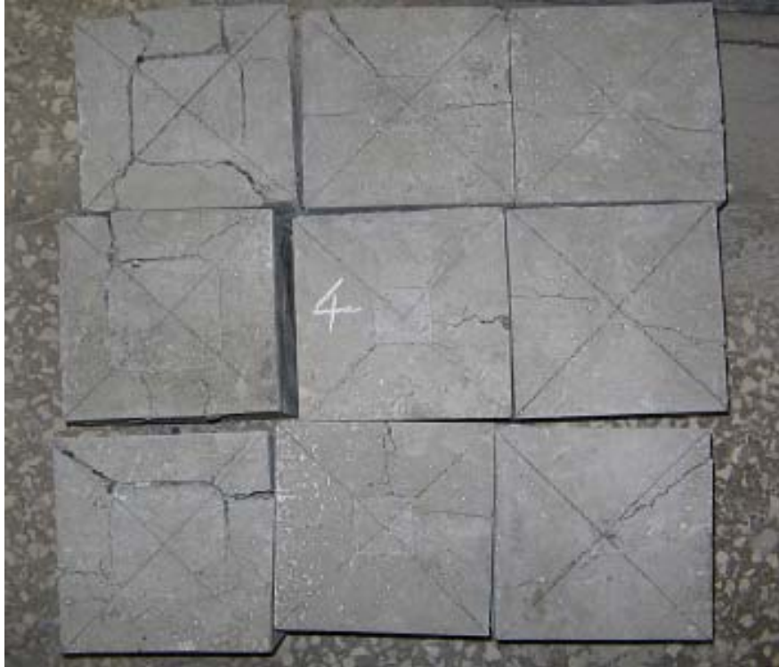
Şekil 4.4 L4 deney numunelerinin göçme şekilleri
