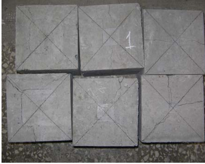
Şekil 4.1 L1 deney numunelerinin göçme şekilleri
