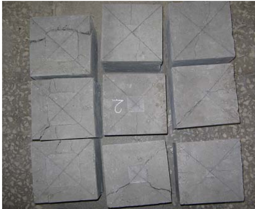
Şekil 4.2 L2 deney numunelerinin göçme şekilleri
