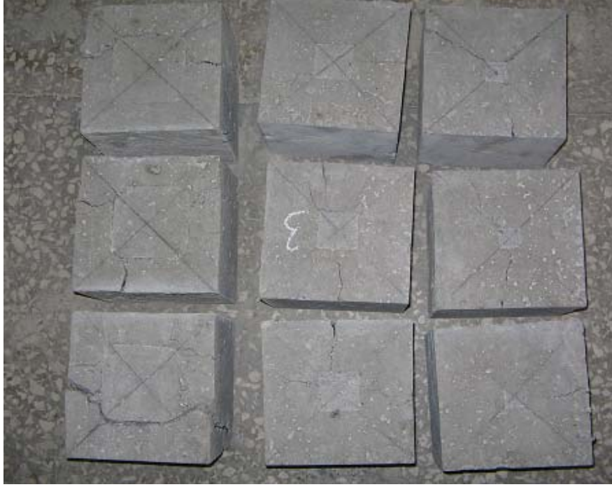
Şekil 4.3 L3 deney numunelerinin göçme şekilleri
