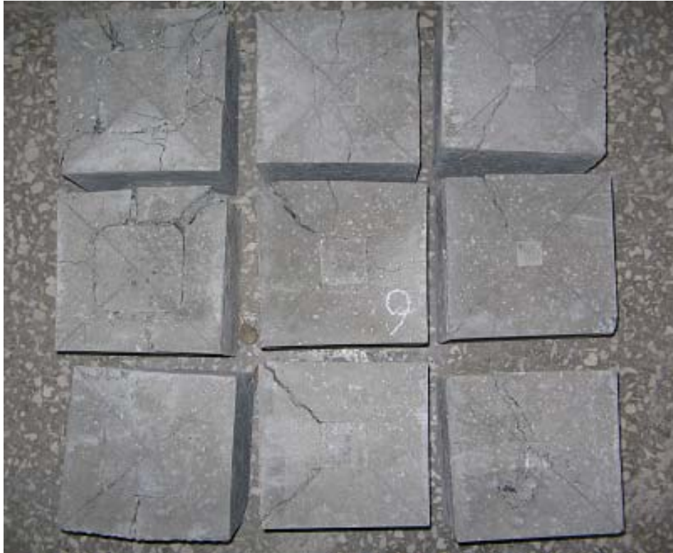
Şekil 4.6 L6 deney numunelerinin göçme şekilleri
