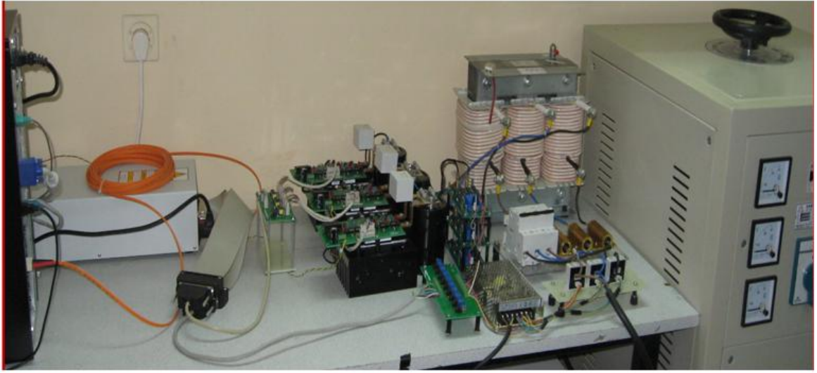
Şekil 5.27. Gerçekleştirilen D-STATKOM deney düzeneği
