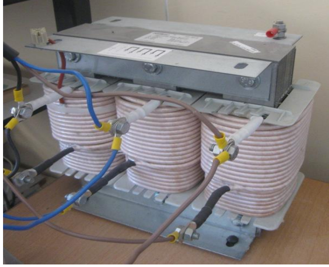
Şekil 5.8. D-STATKOM'un deney düzeneğinde kullanılan üç fazlı bağlantı endüktansı
