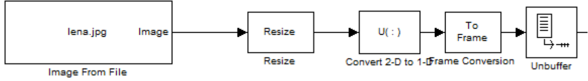
Şekil 4.4 Görüntü ön işleme blok yapısı
