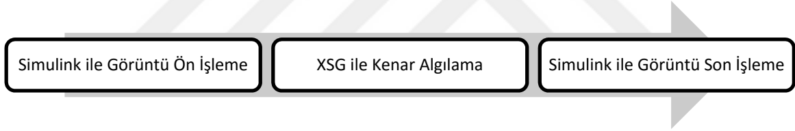
Şekil 4.1 Kenar algılama işlemi için oluşturulan sistem diyagramı
