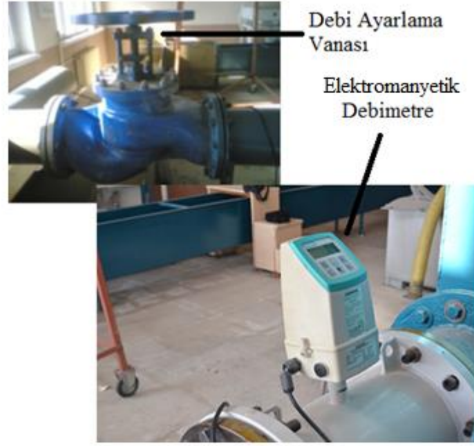
Şekil 5.6 Giriş debisini ölçen elektromanyetik debimetre ve ayarlama vanası
