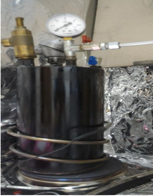
Şekil.E7.3.1: Deney düzeneđi iin zel olarak tasarlanan buhar kazanı
