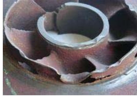
Şekil 3.14 Kavitasyon aşınmasına uğramış pompa
