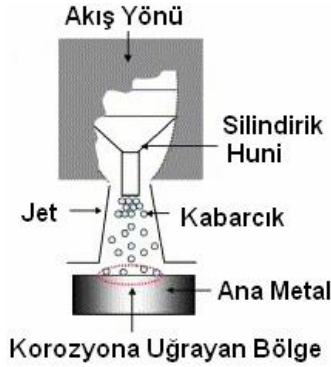
Şekil 3.13 Kavitasyon aşınma mekanizması
