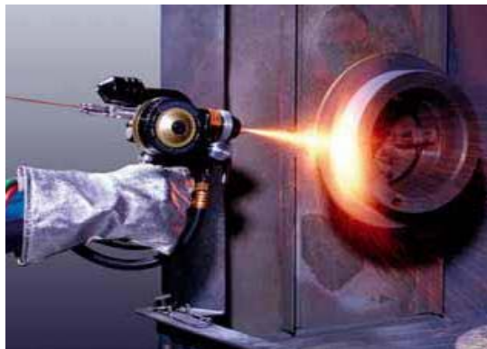
Şekil 4.17 Tel püskürtmeli plazma sprej kaplama
