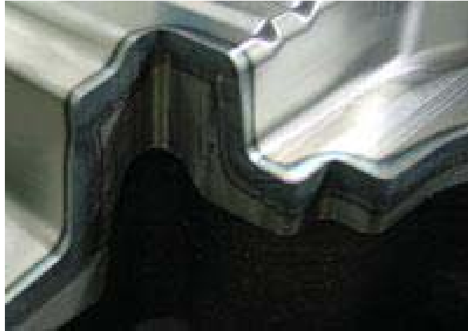
Şekil 4.10 Lazer ile sertleştirilmiş kesme kenarı
