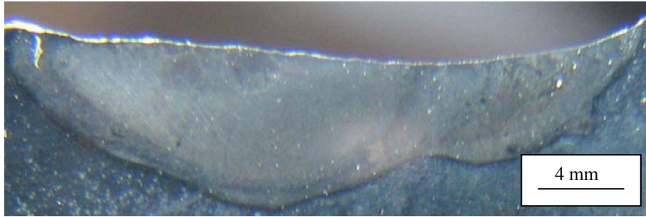
Şekil 7.40 X3 numunesinin kaplama kesiti
