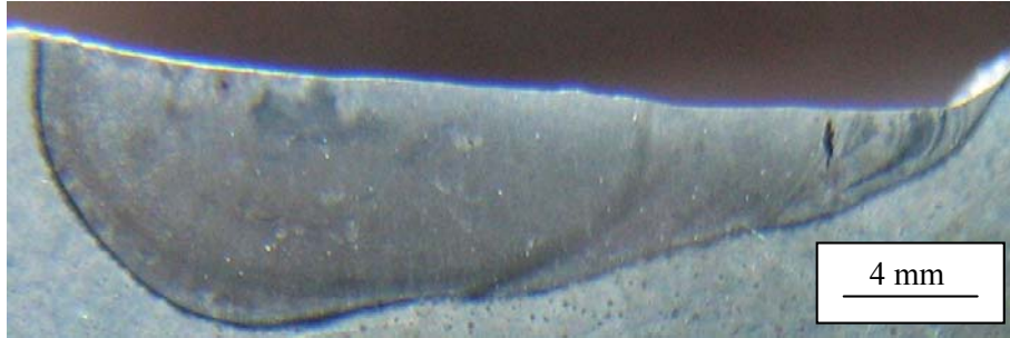
Şekil 7.42 X5 numunesinin kaplama kesiti
