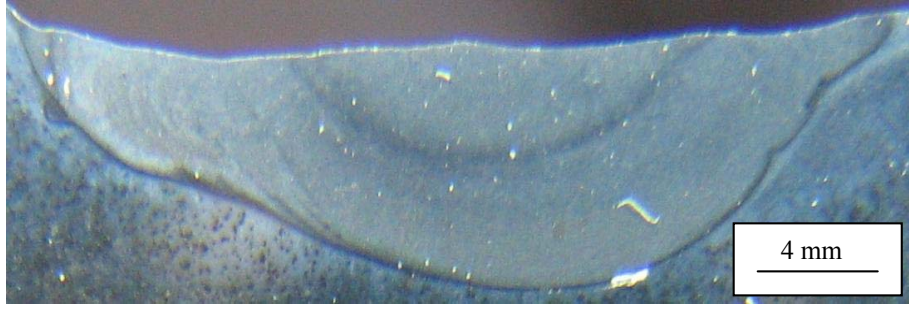
Şekil 7.39 X2 numunesinin kaplama kesiti
