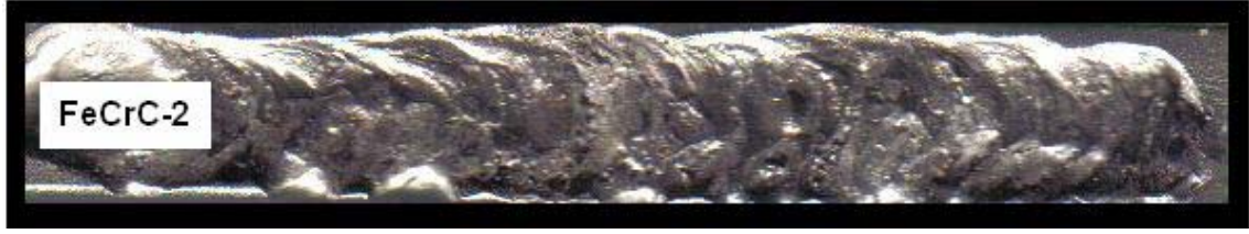
Şekil 6.4 GTA kaplama yapılan FeCrC-2 tozunun makroskopik görünüşü
