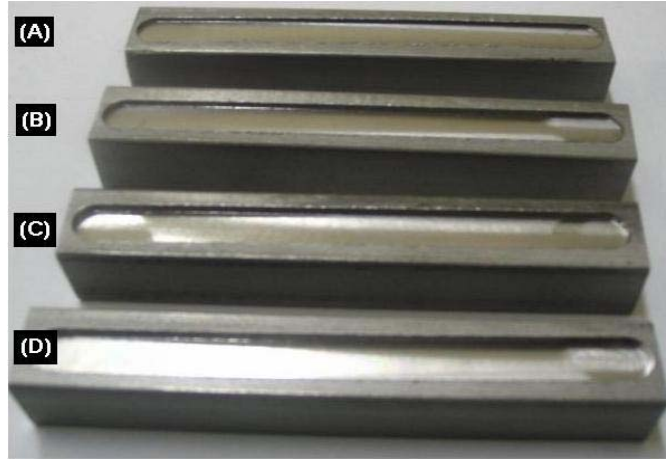
Şekil 6.1 AISI 304 paslanmaz çeliğin kaplama öncesi resmi (A=1 mm, B=1,5 mm, C=2 mm, D=2,5 mm)
