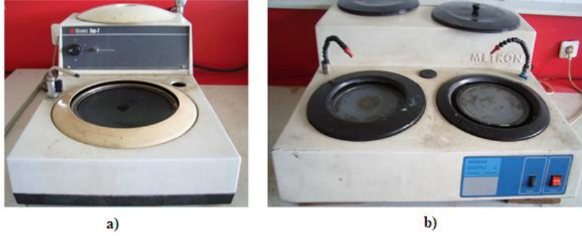
Şekil 5.9. Parlatma cihazları, (a) kaba parlatmaların yapıldığı, (b) ince parlatmaların yapıldığı cihaz
