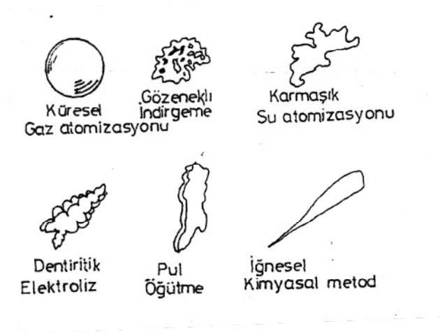
Şekil 2.2. Üretim metotlarına göre toz şekilleri
