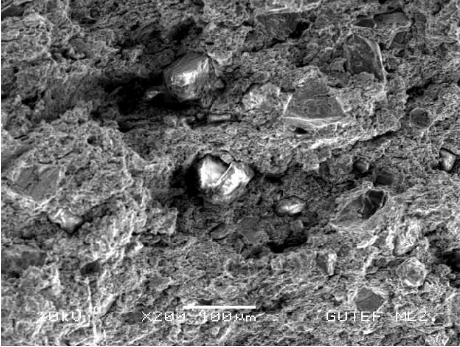
Şekil 9.9. % 6 FeCr oranına sahip 800 °C sıcaklıkta sinterlenmiş numunenin kırık yüzey fotoğrafı
