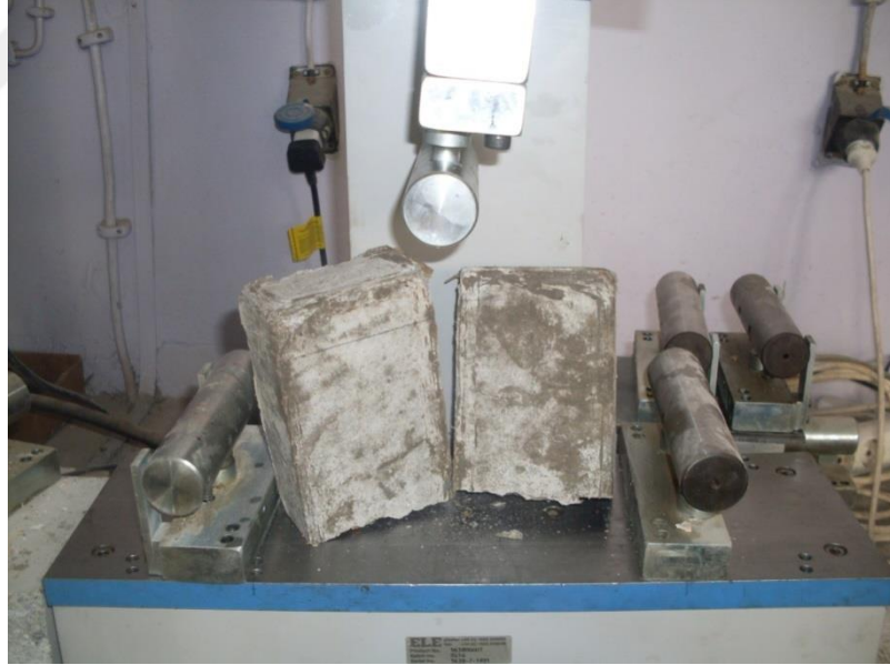
Şekil 4.6. Üç noktalı eğilme deneyi d = 100 \text{ mm}
