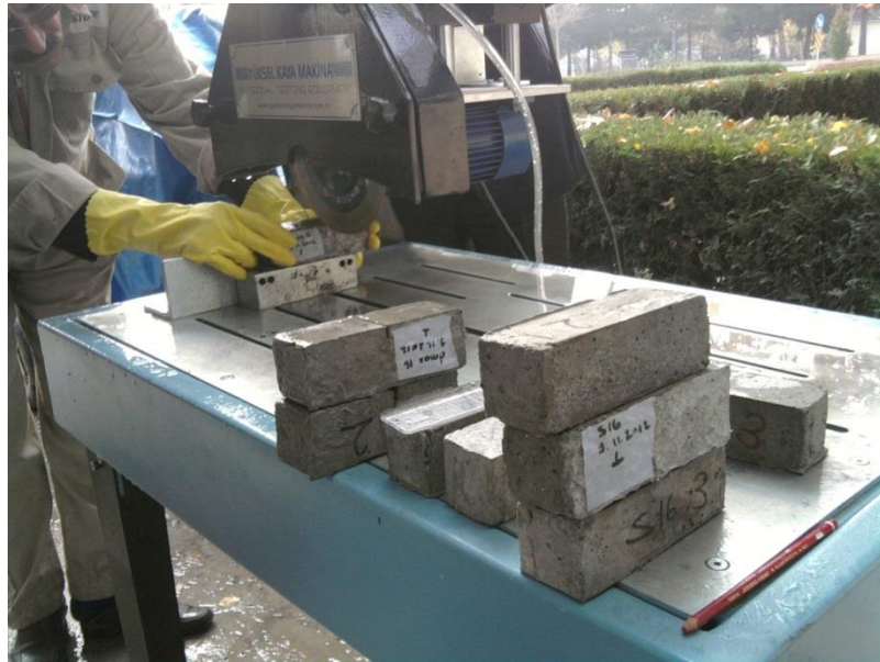
Şekil 4.4. Numunelere çentik açma işlemi
