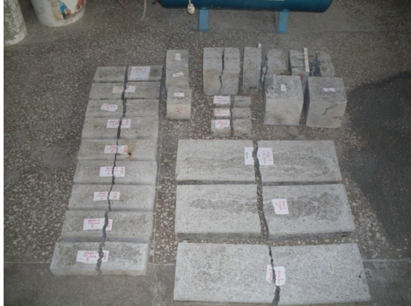
Şekil 4.8. Deney sonucu kırılan numuneler
