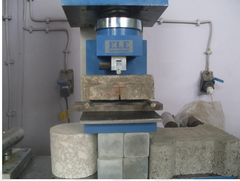
Şekil 4.5. Üç noktalı eğilme deneyi d = 50 \text{ mm}
