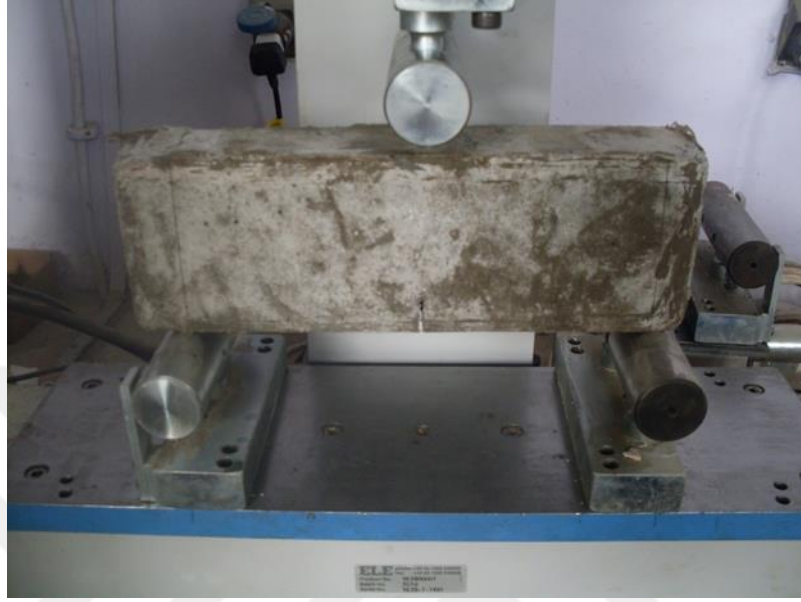
Şekil 4.7. Üç noktalı eğilme deneyi d = 200 mm
