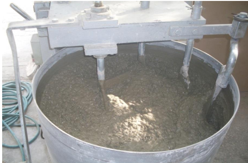
Şekil 4.2. Mikserde beton karışımının oluşturulması
