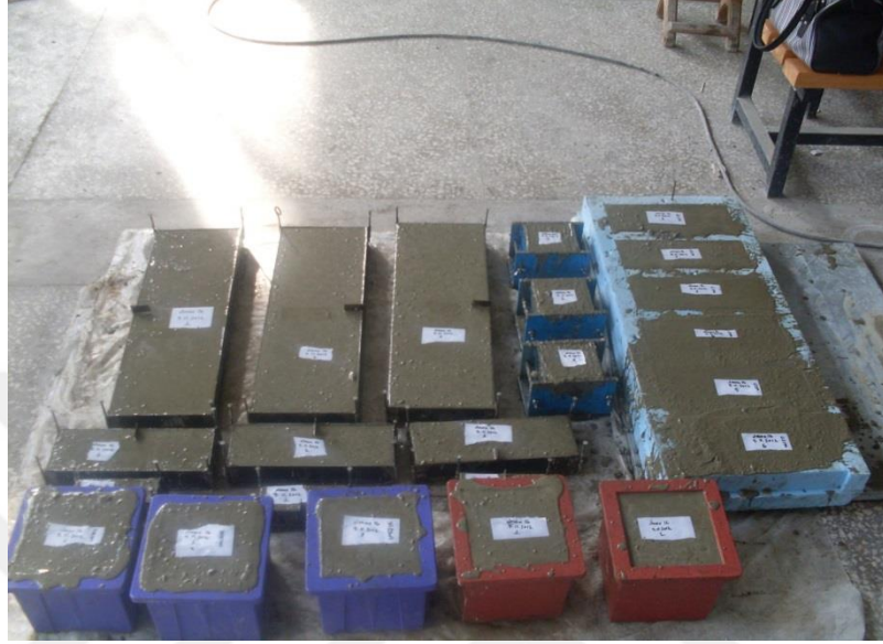
Şekil 4.3. Karışımın kalıplara dökülmesi
