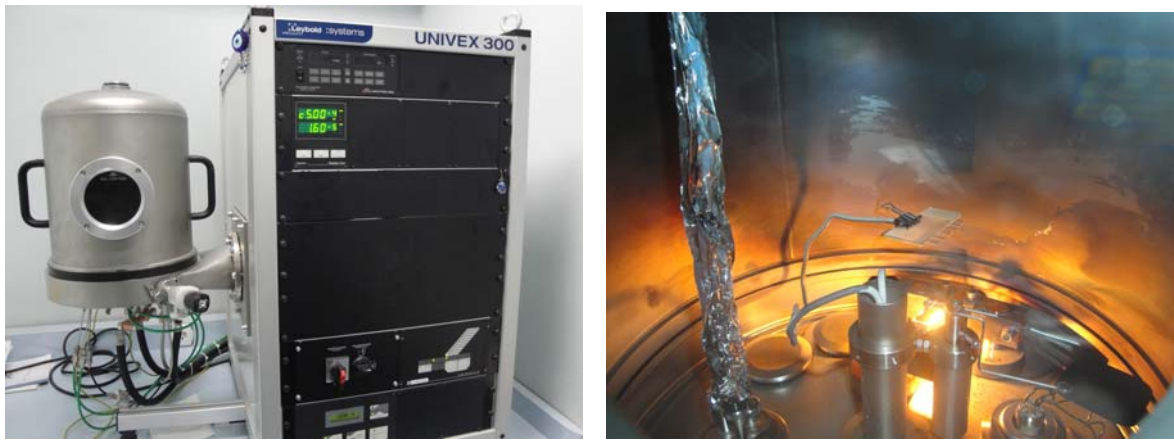
Şekil 3.4. a-) Termal buharlaşma sisteminin dış görünüşü, b-) buharlaşma işlemi sırasında sistemin içersinin görünümü.
