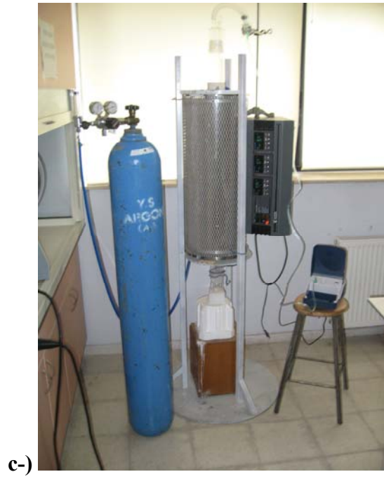
Şekil 3.2. a-) Nebulizasyon sisteminin bileşenleri, b-) fırın içerisine yerleşecek şekilde toplanmış hali, c-) sistemin kullanıma hazır durumu.
