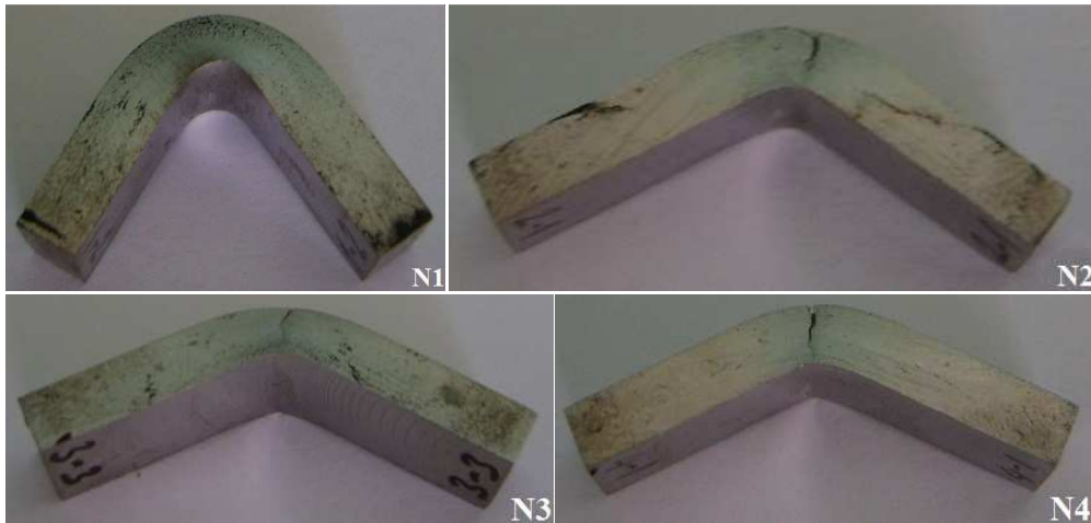
Şekil 6.2. Üç noktalı eğme deneyi ile plastik şekil değişimine uğramış numuneler
