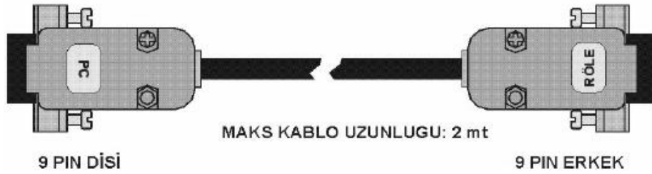
Şekil 3.7 Standart 9-pin dişi ve 9-pin erkek D-sub konektörünün bağlantısı
