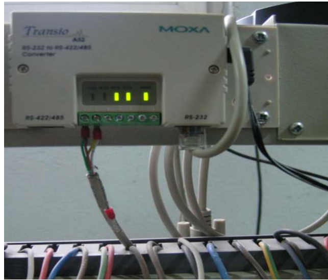
Şekil 2.7 Moxa converterin sistemdeki bağlantısı
