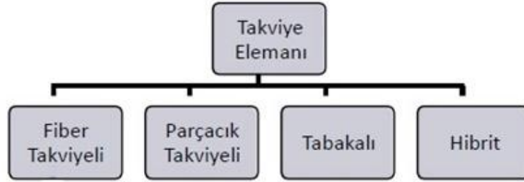
Şekil 2. 13. Takviye elemanlarına göre kompozit malzemelerin sınıflandırılması
