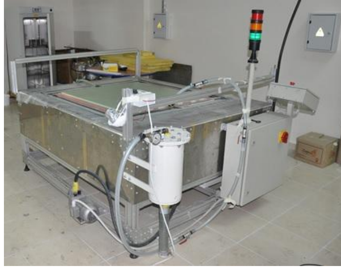
Şekil 2. 17. Vakum infüzyon yöntemi
