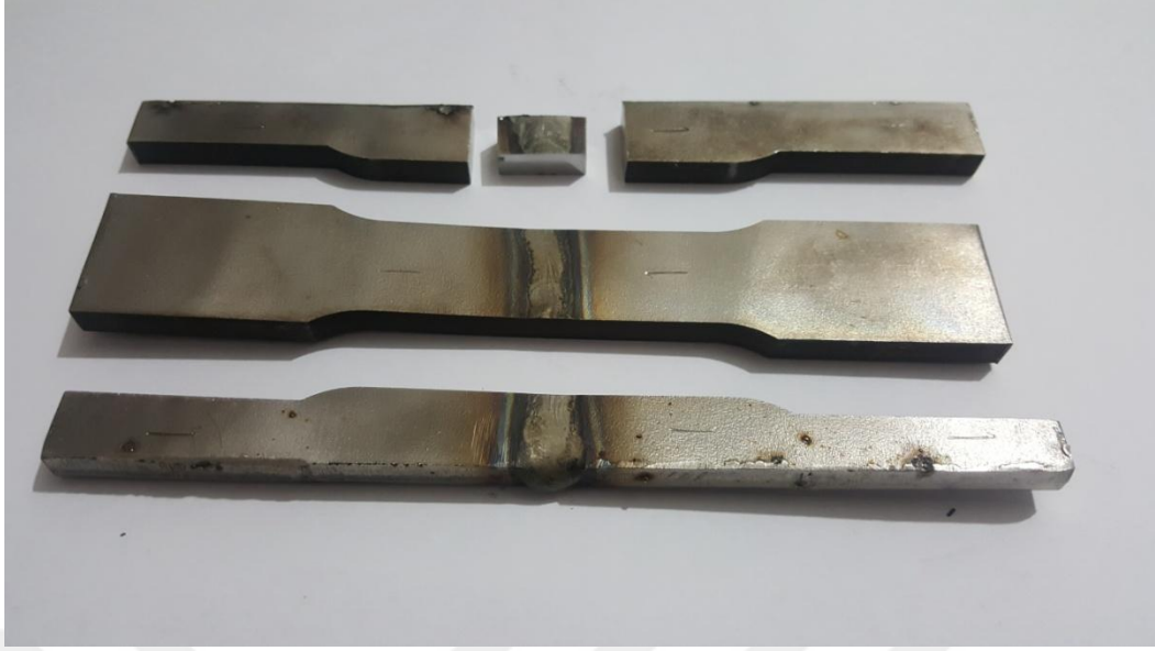
Şekil 4.8. Kaynaklı numunelerin Tel erezyon kesimi sonrası
