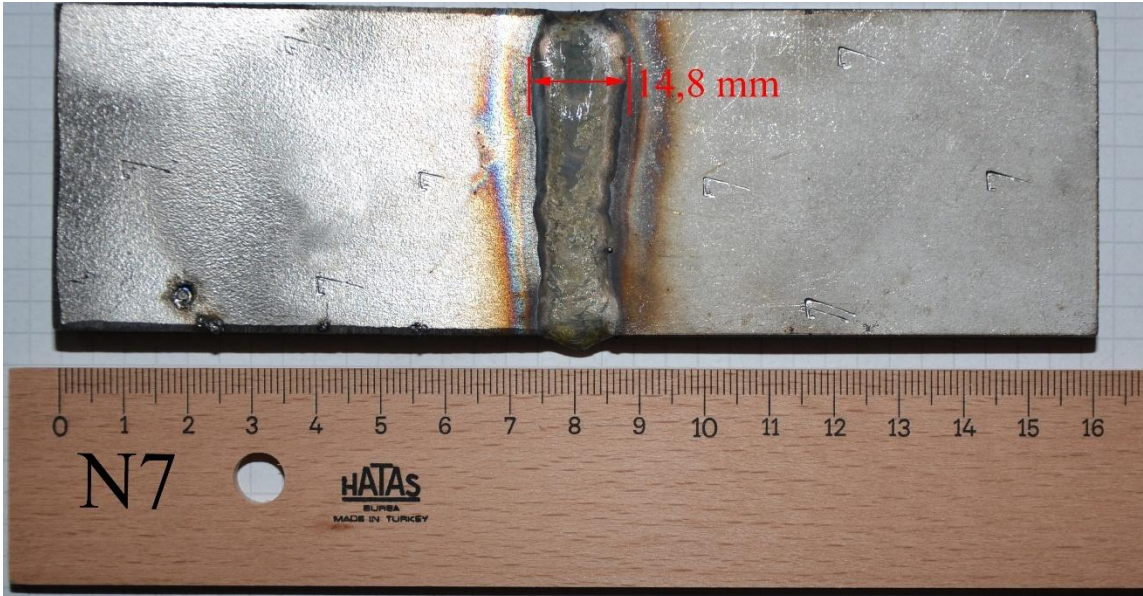
Şekil 5.10. N7 numunesinin kaynak sonrası görüntüsü
