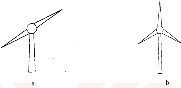
Şekil 6.3 Propeller Türbinler (a-Çift Kollu, b-Üç Kollu)
