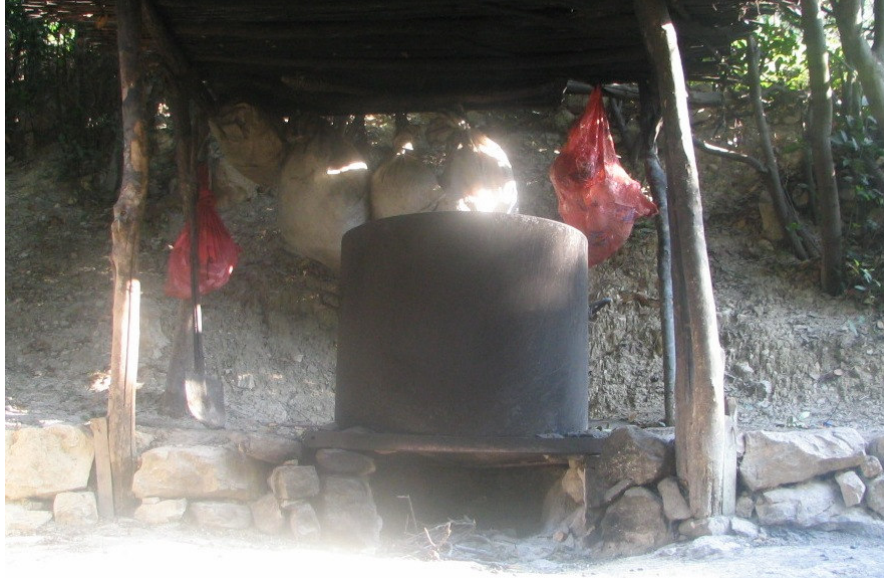
Foto 39: Sabun, zeytinyağı ve defne yağının kazanlarda kaynatılması ve bazı kimyasal işlemlerden geçirilmesi sonucunda elde edilir.
