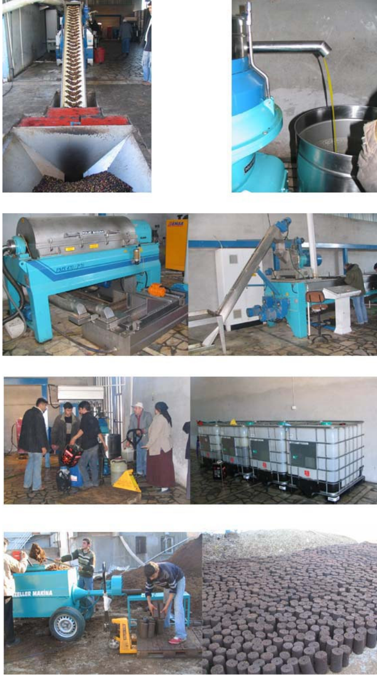
Foto 48: Şah-süt zeytinyağı fabrikasında zeytinlerin yağ elde etmek için geçirildiği işlemler ve prima odunu elde edilmesi
