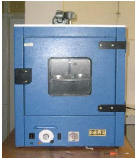
Şekil 1. İnce film halinde ısıtma deney aleti (Thin film oven test device)
