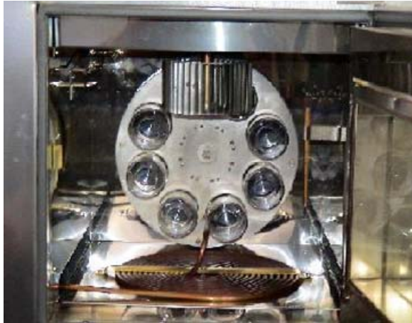
Şekil 2. Dönel ince film halinde ısıtma deney aleti (Rolling thin film oven test device)
