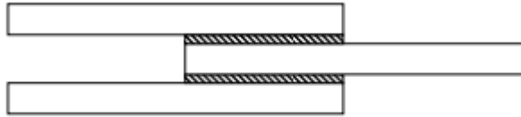
Şekil 2.7. Çift bindirmeli bağlantı
