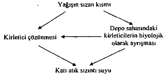
Şekil 2.1 Sızıntı Suyu Oluşumu ve Katı Atıklardan Sızıntı Suyuna Kirlenici Geçiş (Öztürk, 1999)
