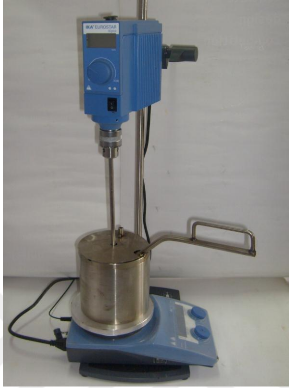
Şekil 4.2. Modifiye bitüm karıştırma cihazı.
