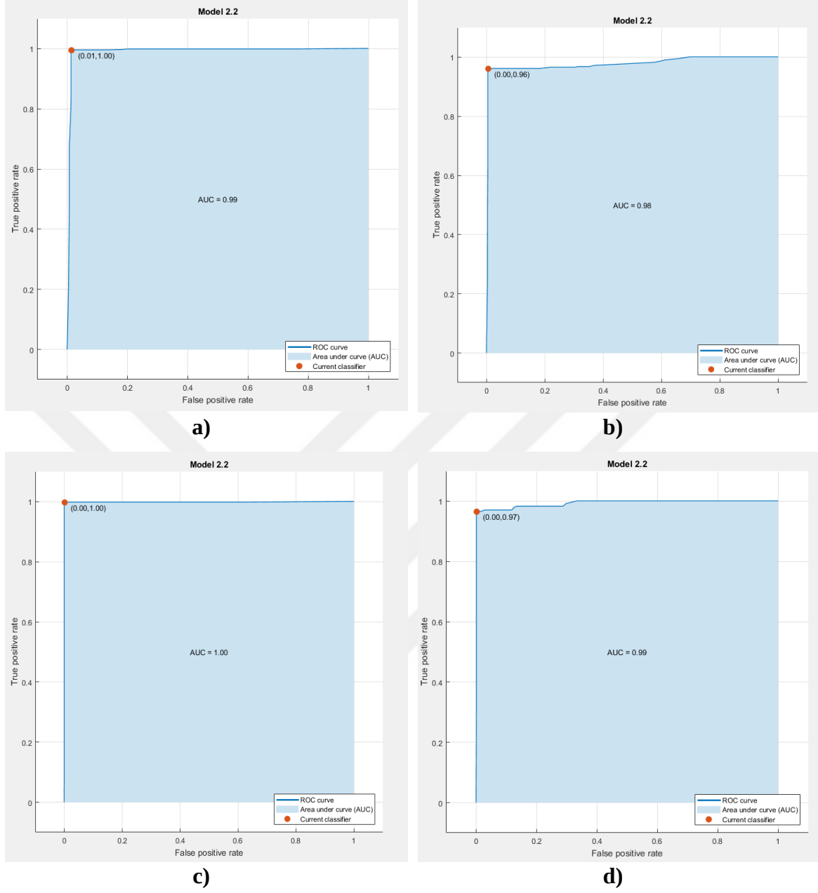
Şekil 4.18. Karar ağacı sınıflandırıcısı sonucunda oluşan ROC eğrileri a) Fiziksel hata b) Fiziksel ve Yoğunluk hatası c) Sağlam d) Yoğunluk arızası
