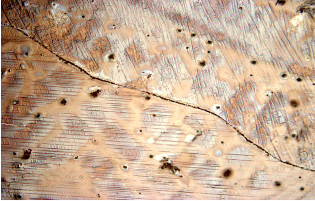
Şekil 6. 101: 2B numunesine ait martensit morfolojisi (x500).
