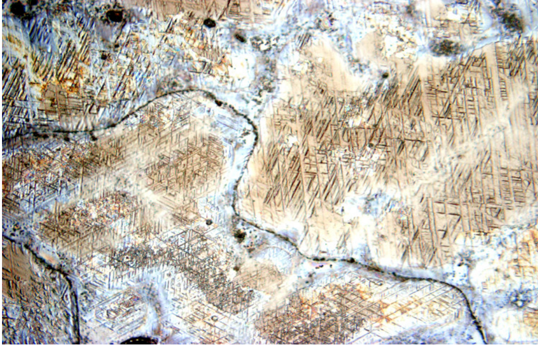
Şekil 6. 97: 1B numunesine ait martensit morfolojisi (x1000).
