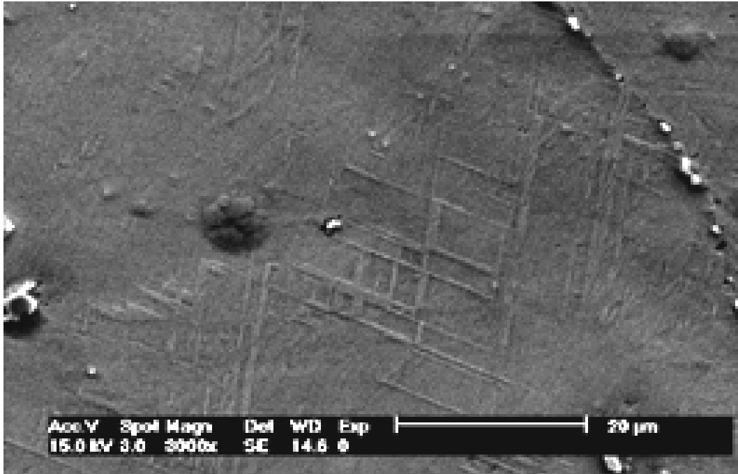
Şekil 6. 90: 3D numunesine ait martensit plakaları ve çökelti fazları (x3000).
