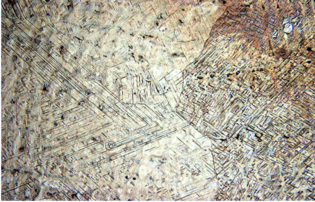
Şekil 6. 111: 4D numunesinde görülen martensit yapıları (x200).
