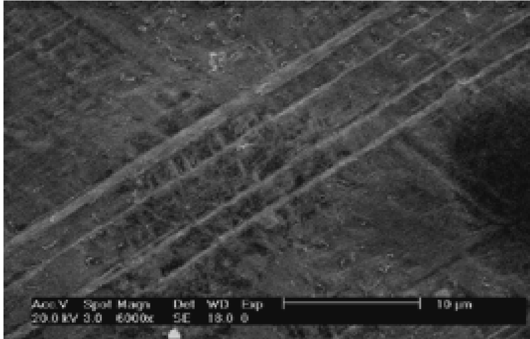
Şekil 6. 85: 2C numunesinde boydan boya uzanan martensit plakaları (x6000).
