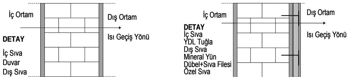
Şekil 3.17. Uygulamada Kullanılan Tuğla Duvarın Yalıtımdan Önceki ve Sonraki Durumu
