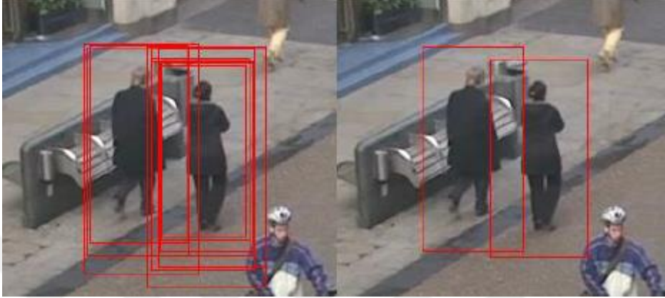
Şekil 5.15. Non-maximum suppression algoritması öncesi ve sonrası [98].
