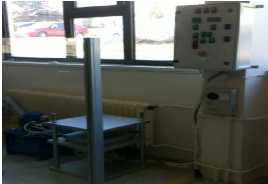
Şekil 3.5. Hidrolik pompa, hidrolik sıcak pres ve kontrol ünitesi
