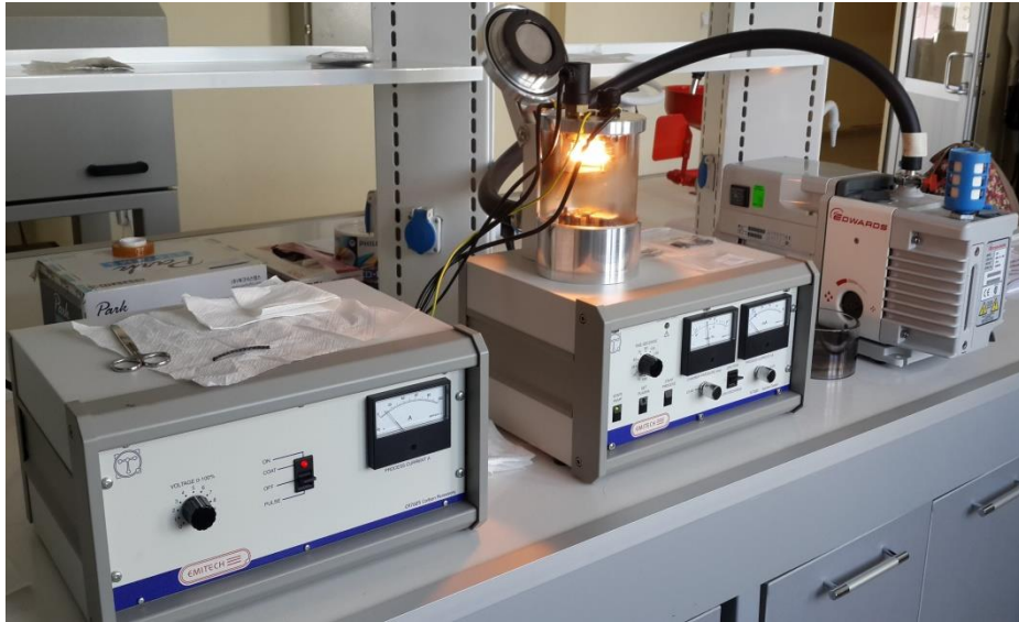
Şekil 4.34. Karbon kaplama yöntemi
