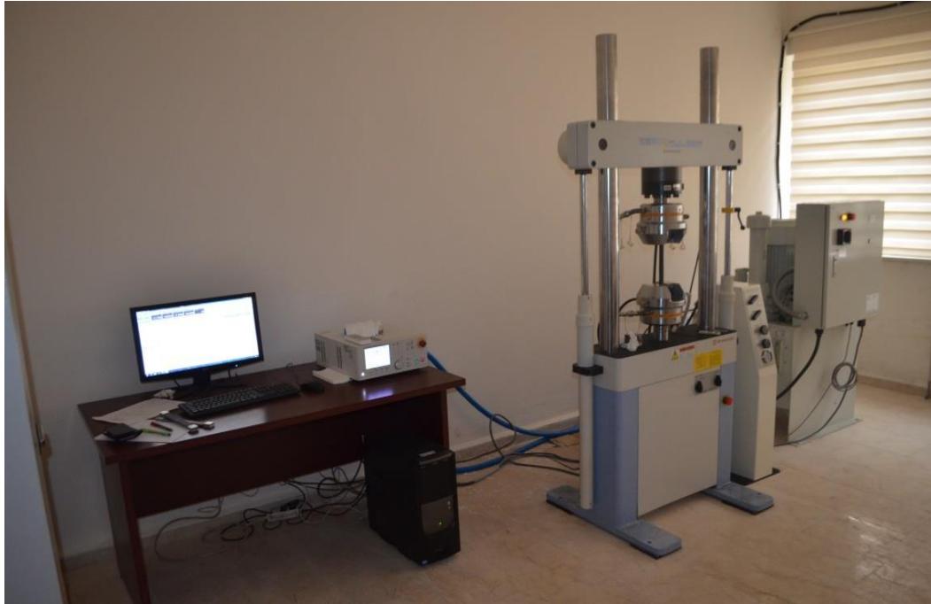
Şekil 3.8. Yorulma deney düzeneği
