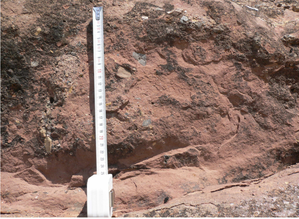
Şekil 4.8b. Kırmızı renkli masif kumtaşı fasiyesi. İçerisinde saçılı halde kayaç parçaları yer alıyor. ÖSK - 1, 1-3 metreler arası.
