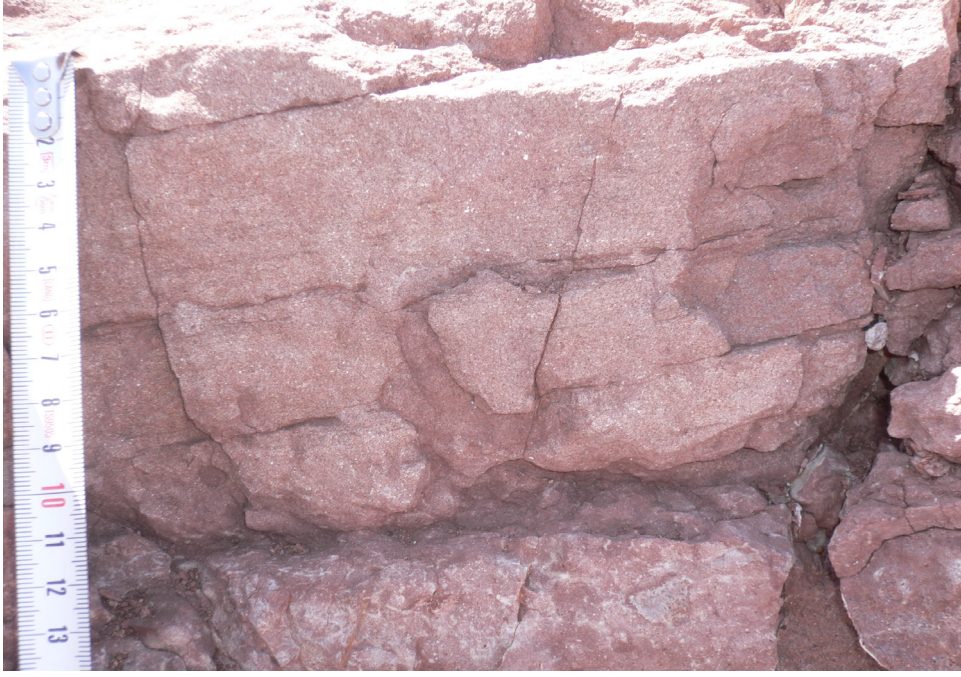
Şekil. 4.7. Tabakalı kumtaşı fasiyesi. Yoğun laminalı düzeyler içeriyor. ÖSK - 5, 72 - 74 metreler arası.
