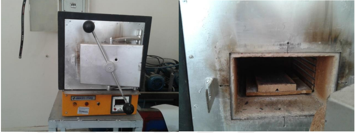
Şekil 4.5. Isıl işlem basamaklarında kullanılan fırın
