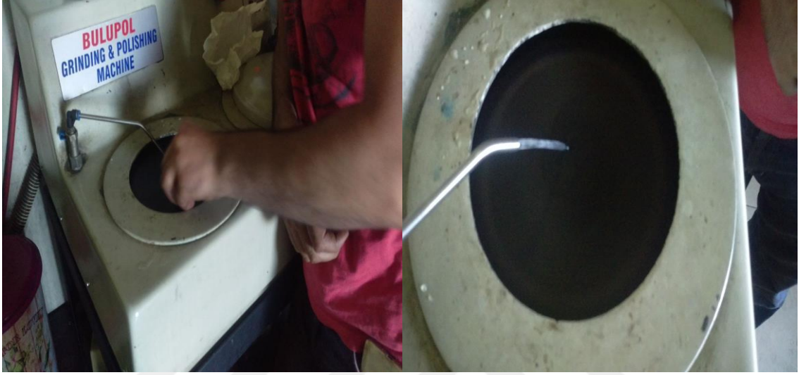
Şekil 4.7. Numunelerin zımparalanması işlemi
