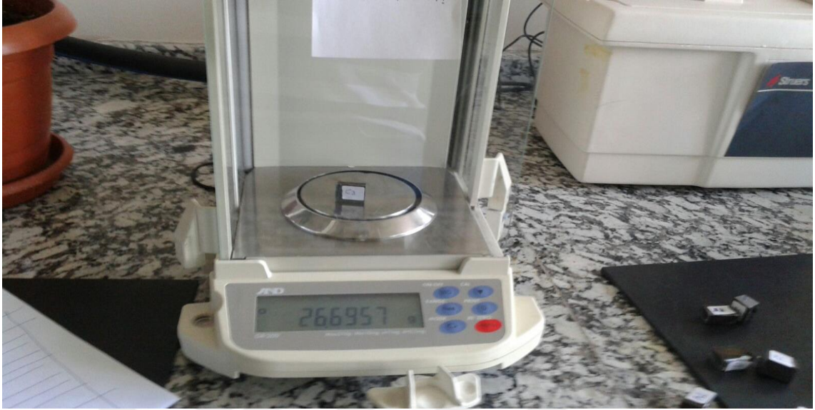
Şekil 4.19. Numunelerin aşınma testi öncesi kütle tespitinin yapılması
