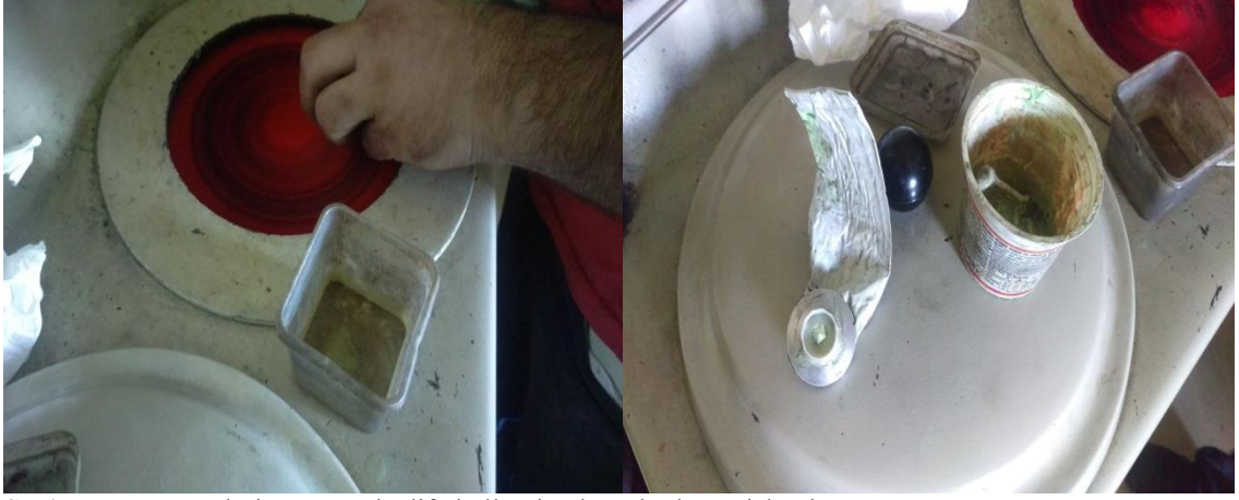
Şekil 4.9. Numunelerin cıva ve kadife kullanılarak parlatılması işlemi
