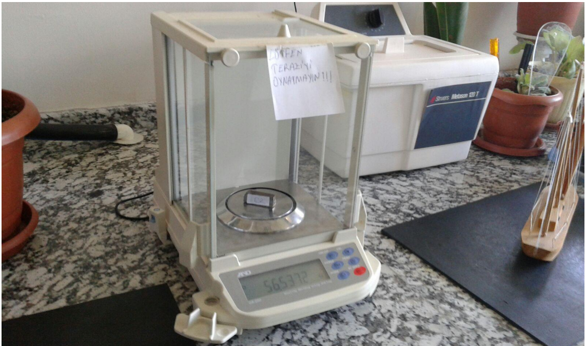
Şekil 4.20. Aşınan numunelerin kütle kaybını ölçmede kullanılan hassas terazi
