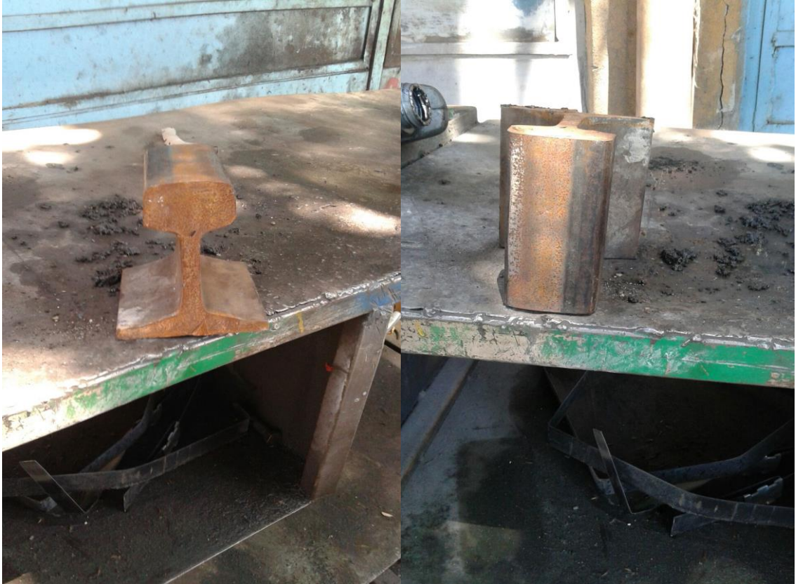
Şekil 4.1. S49 ray çeliği numunesi
