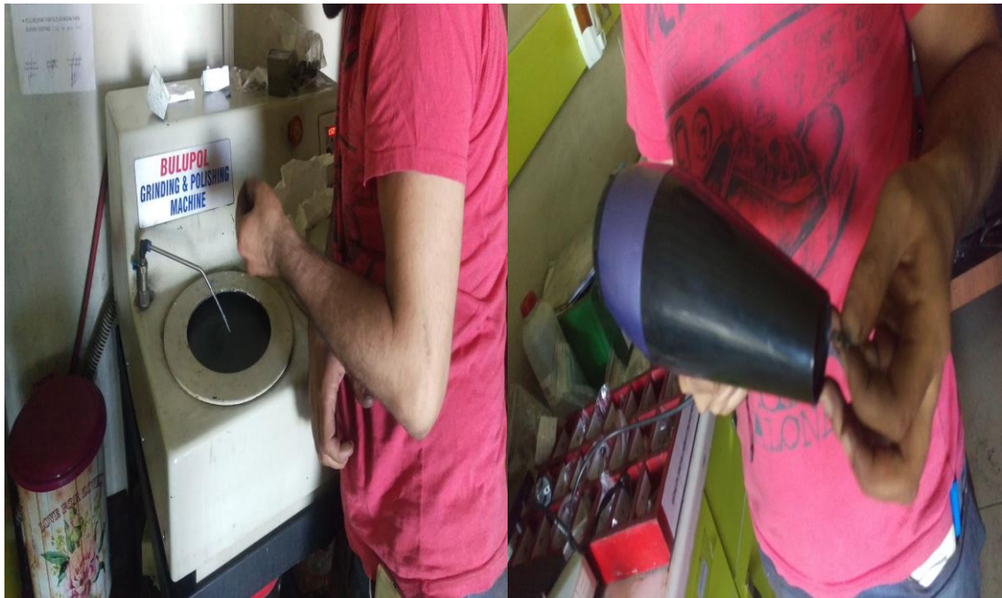
Şekil 4.15. Aşındırılacak numunelerin çapaklarını giderme ve alkol ile temizleme
