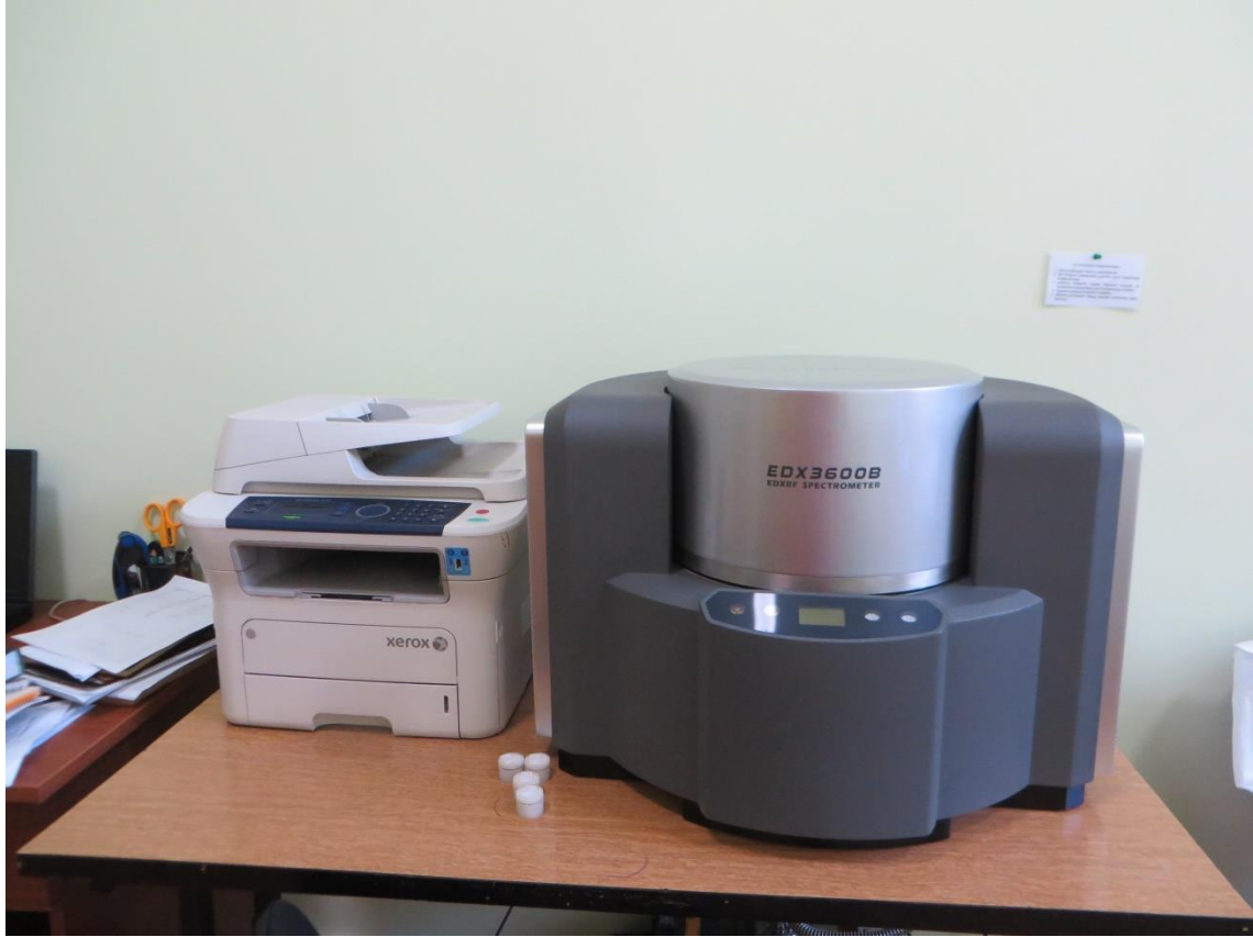
Şekil 4.2. Numunelerin spektral analizlerinin yapıldığı EDX3600B cihazı
