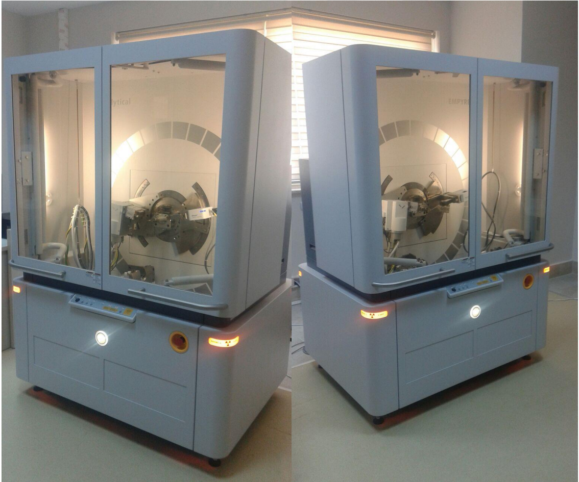
Şekil 4.13. Mikroyapı incelemesinde kullanılan XRD cihazı
