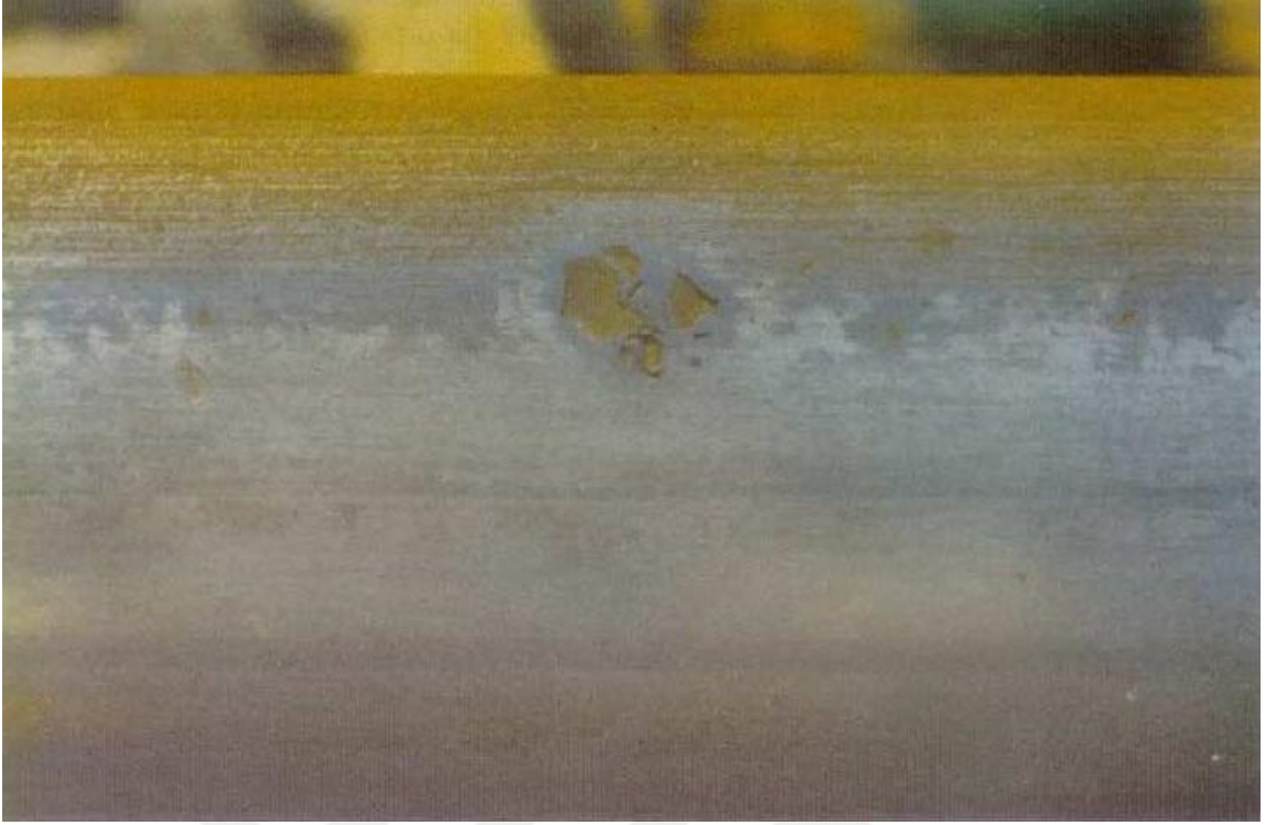
Şekil 2.7. Ray yüzeyinde oluşan abrasiv aşınma (Büyükkelleci, 2008)
