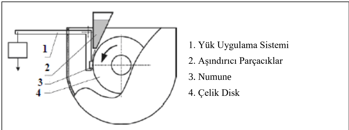
Şekil 3.8. ASTM G65-94 abrasif aşınma cihazı (Klaasen, 2006)
