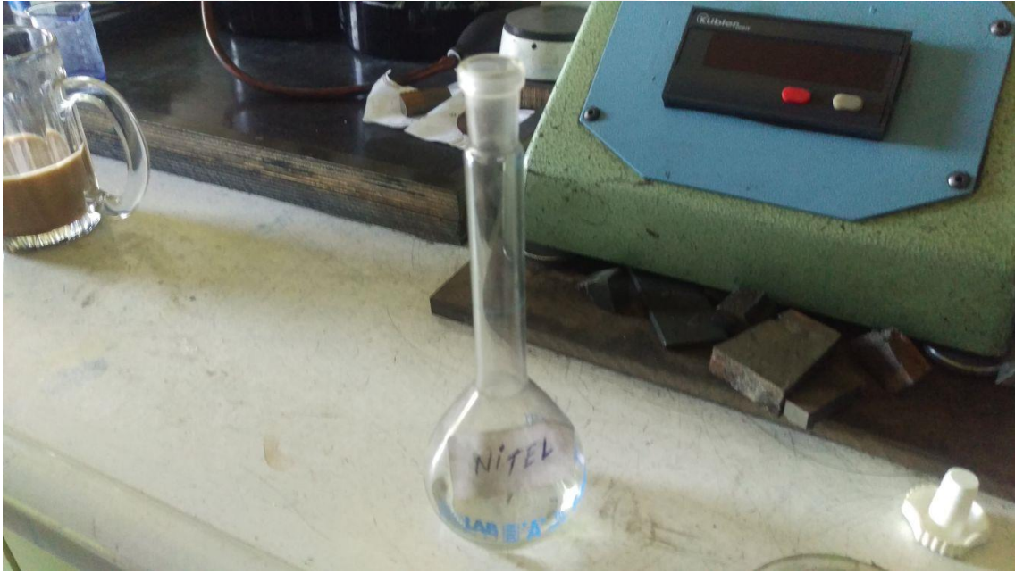
Şekil 4.10. Numunelerin dağlanması işleminde kullanılan nital çözeltisi
