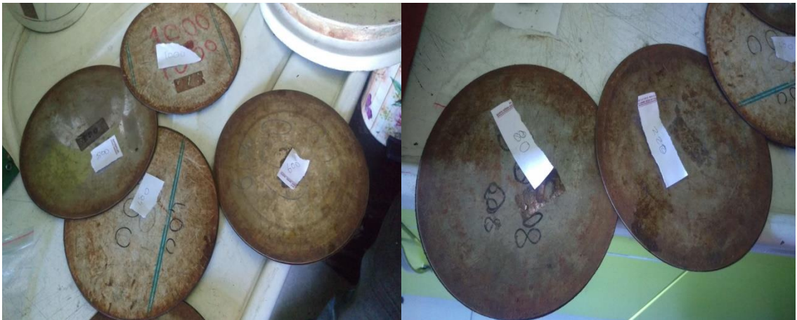
Şekil 4.8. Numunelerin parlatılması işleminde kullanılan zımparalar
