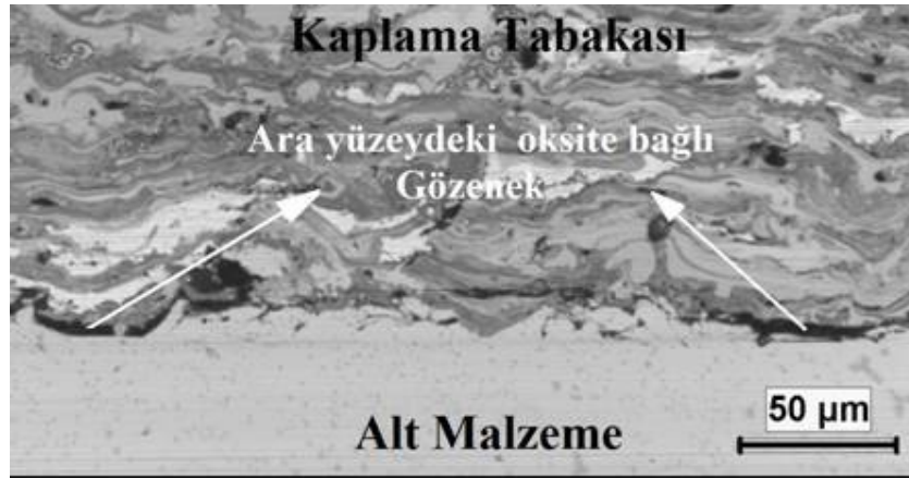
Şekil 9.74. D grubu numunelerde ara yüzeyde meydana gelen oksit tabakası.
