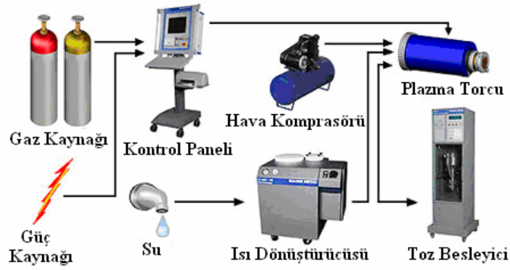
Şekil 6.2. Kontrol panelli atmosferik plazma püskürtme sisteminin şekli (www.sulzermetco.com).
