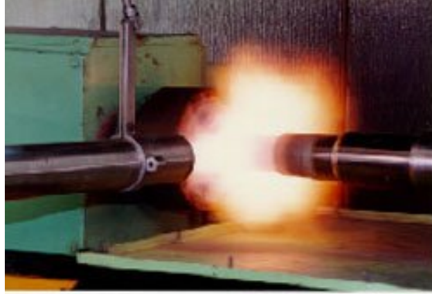
Şekil 5.6. Silindirik altlık malzemesinin patlamalı püskürtme yöntemi ile kaplanması.
