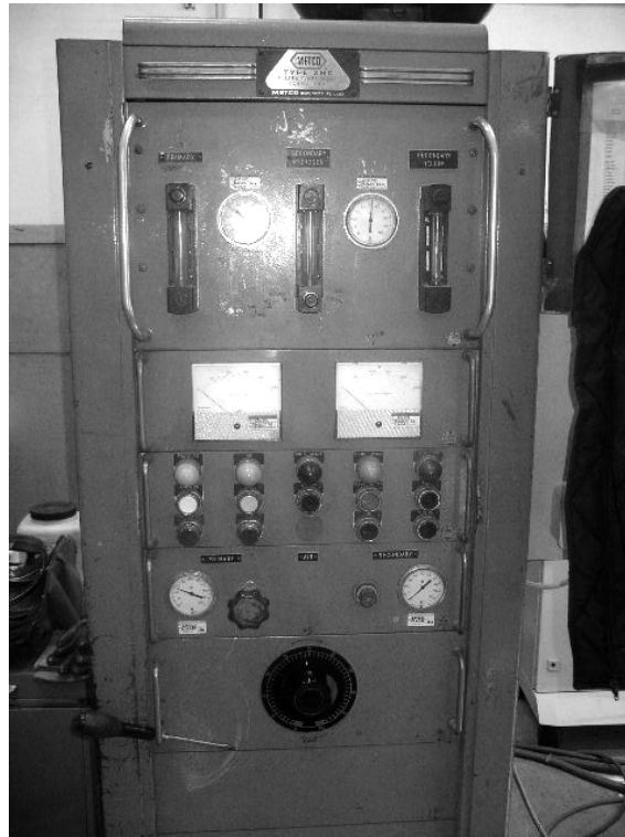
Şekil 6.3. Atmosferik plazma püskürtme sisteminin güç kaynağı.
