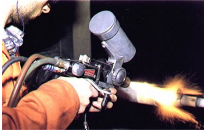
Şekil 5.3. Alevle toz püskürtme ile gerçekleştirilen kaplama işlemi.
