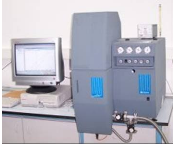
Şekil 8.13. Isıl genleşme ölçümleri için dilatometre cihazı.
