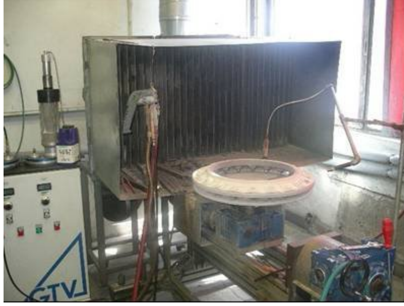
Şekil 8.6. Kaplama işleminin gerçekleştirildiği atmosferik plazma püskürtme sistemi.
