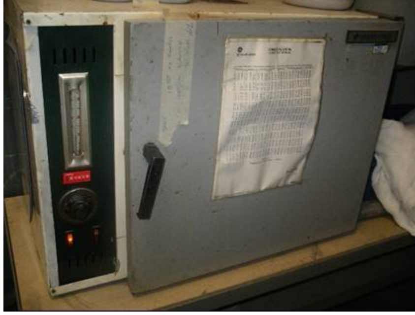
Şekil 8.9. Çekme deney numuneleri için ısıtım fırını.
