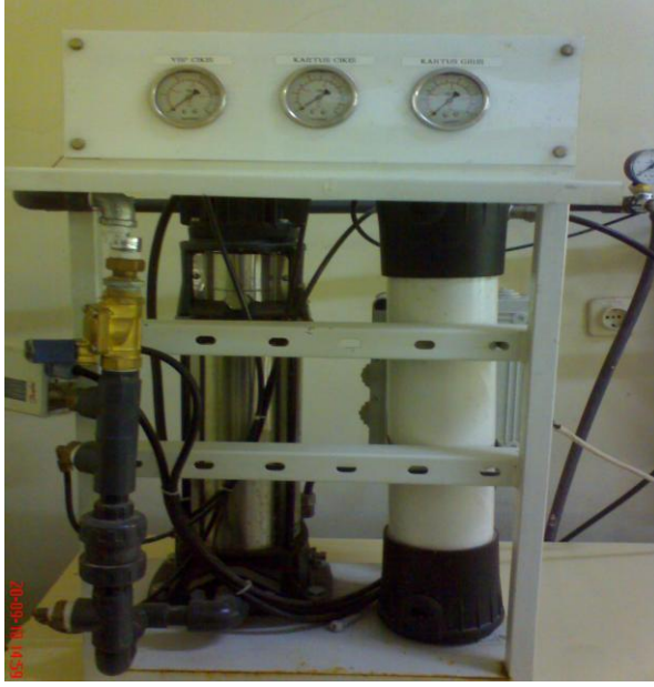
Şekil 4.5. TO membranı, basınç motoru ve basınç göstergeleri
