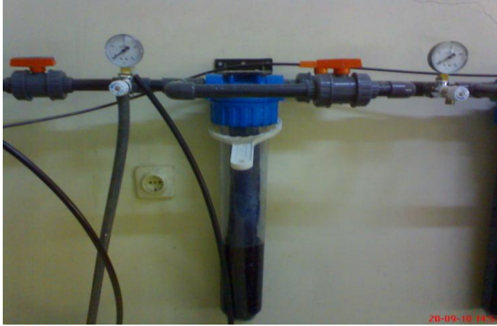
Şekil 4.3. MF membranı ve giriş-çıkış basınç göstergeleri
