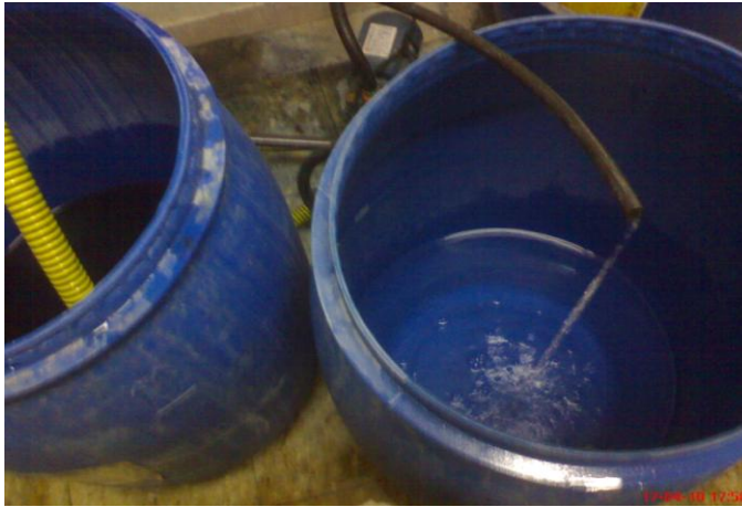
Şekil 4.7. TO girişindeki (MF çıkışındaki) atıksu ve TO çıkışındaki ürün suyu
