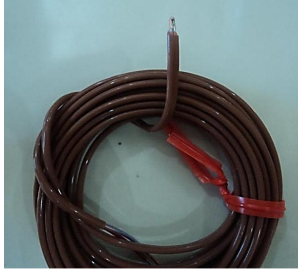
Şekil 2.8. Isıl çift (bakır ve kostantan) uçlarının lehimlenmiş görünümü
