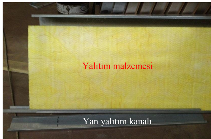
Şekil 2.2. Kollektörün yalıtım aşaması
