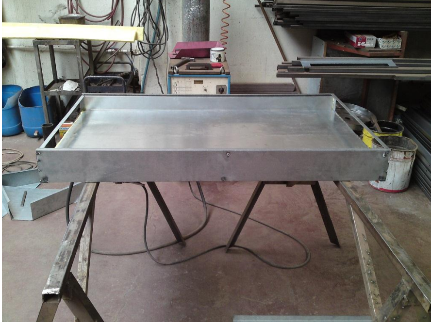
Şekil 2.3. Kollektörün yalıtım işleminden sonraki imalat aşaması
