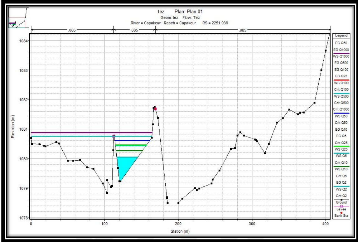
Şekil 5.28. 2251.93 nolu enkesit için taşkın kotları (Çapakçur Çayı)
