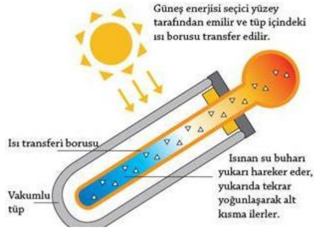
Şekil 1.36. Vakum tüplü kolektör ve çalışma şekli[65]
