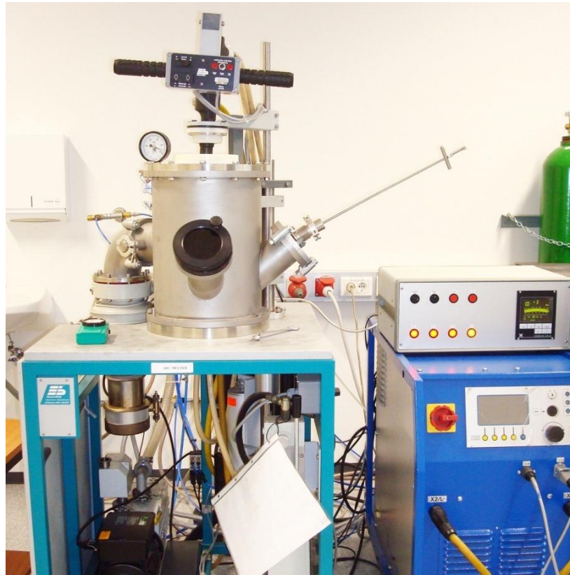
Şekil 6.1. Edmund Buehler Arc Melter ergitme fırını.
