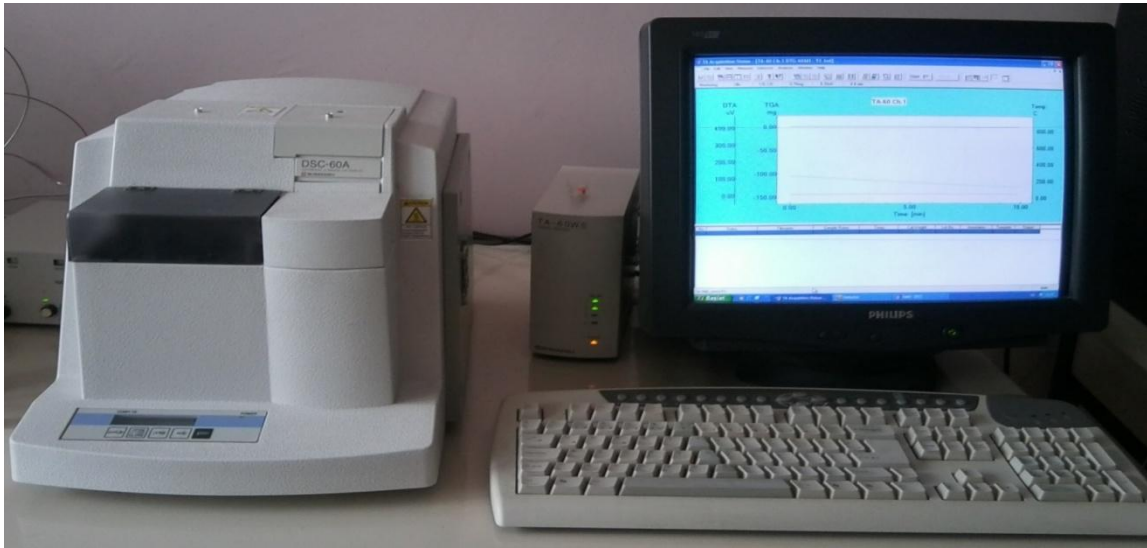
Şekil 6.3. Shimadzu DSC-60A Diferansiyel taramalı kalorimetri cihazı.
