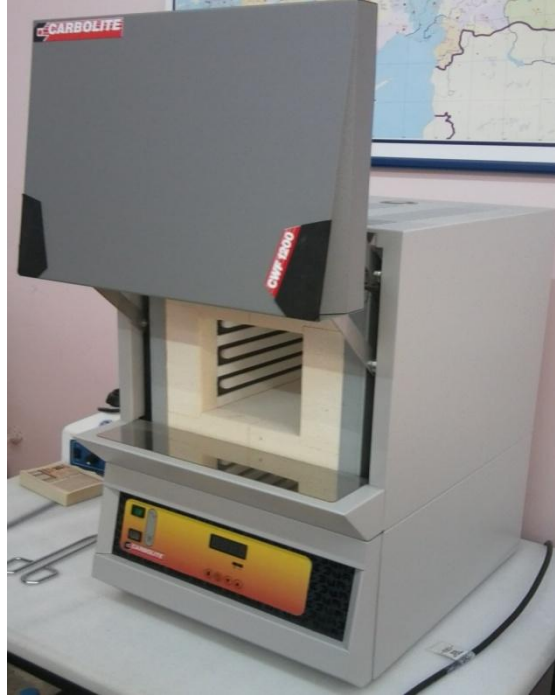
Şekil 6.2. Carbolite CWF-1200 kül fırını.
