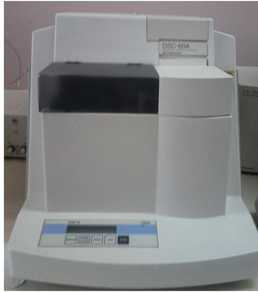
Şekil 7.34. Shimadzu DSC-60A Diferansiyel taramalı kalorimetri cihazı.
