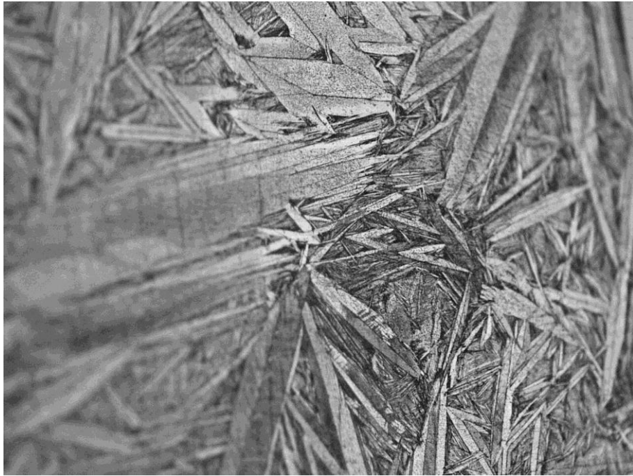
Şekil 7.21. CAM-1 300 °C de yaşlandırılmış alaşımına ait 100μm büyütme ile çekilen yüzey mikrografı.
