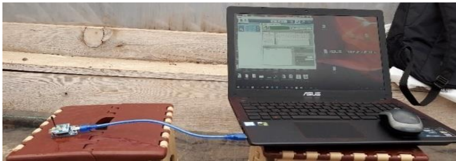
Şekil 5. 6. Koordinatör Xbee düğümü
