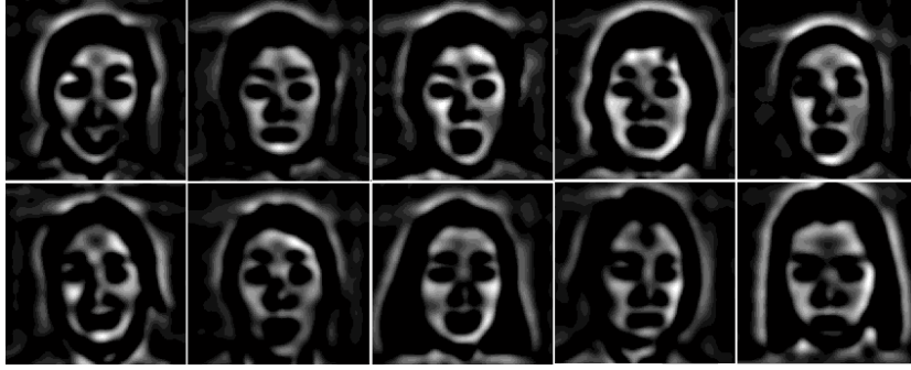
Şekil 4.10. Adaptif LoG uygulaması için örnek çıkış imgeleri
