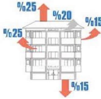
Şekil 2.2. Binalarda ısı kayıpları [47].
