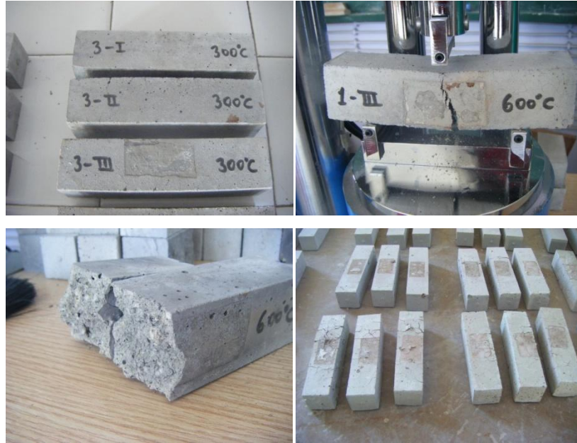
Şekil 4.15 300, 600 ve 900°C sıcaklıklara maruz kalmış harç numuneleri
