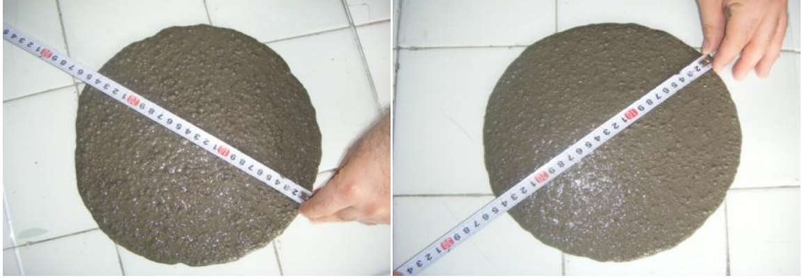
Şekil 4.5 Mini ökme yayılma ölçümü
