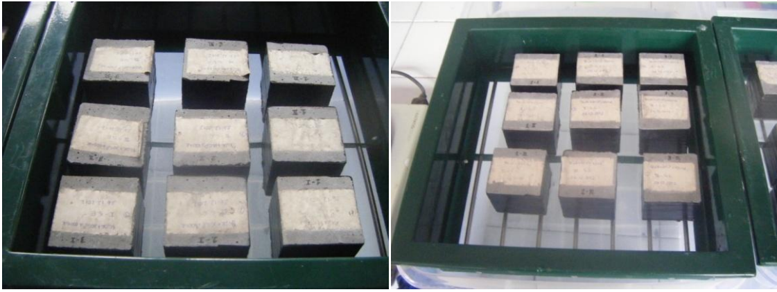
Şekil 4.13 Kılcal su emme deneyi
