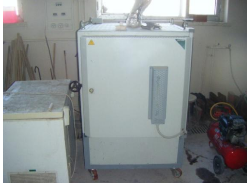
Şekil 4.14 Yüksek sıcaklık testlerinde kullanılan fırın
