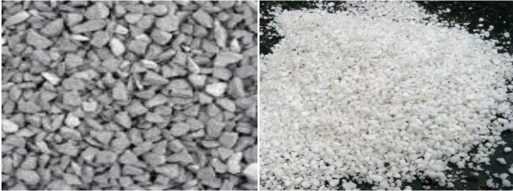
Şekil 3.6 Ham perlit ve genleştirilmiş perlit
