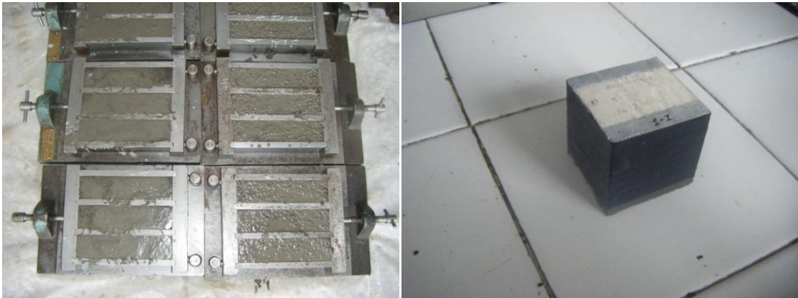
Şekil 4.9 40x40x160 mm prizmatik ve 50 mm küp numuneler
