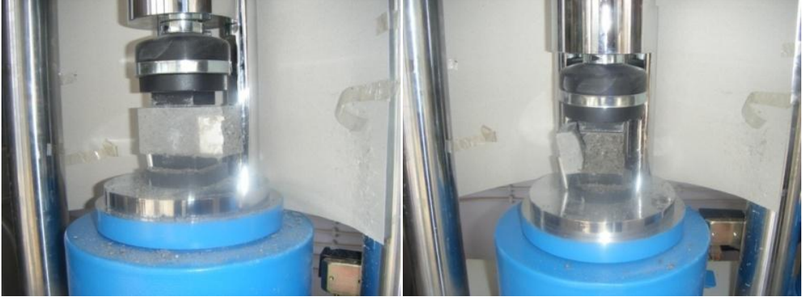
Şekil 4.11 Basınç dayanımı deneyi
