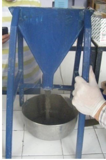
Şekil 4.7 Mini V-hunisi deney ölçümü
