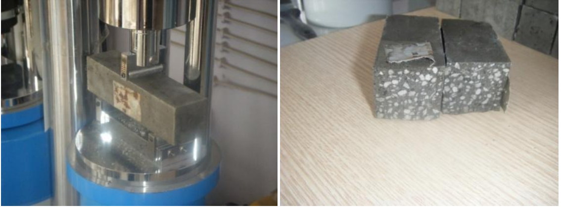
Şekil 4.10 Eğilmede çekme dayanımı deneyi
