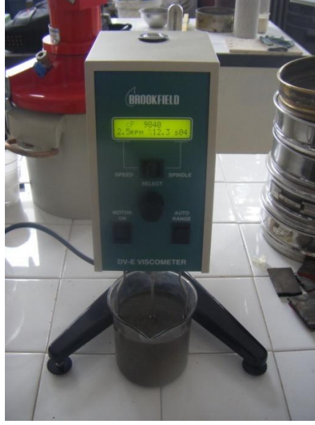
Şekil 4.8 Brookfield DV-E model viskozimetre
