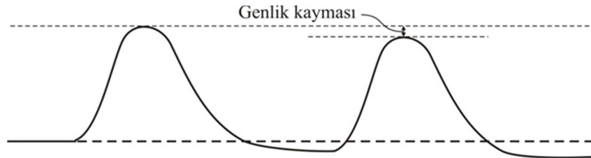
Şekil 1.15. Sıfır kutup düzeltmesinin yapılmadığı durumda radyasyon sinyalleri.
