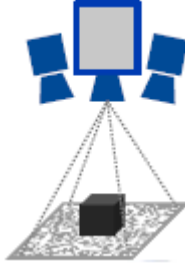
Şekil 2.11. Active Stereo Vision Tekniği [17]
