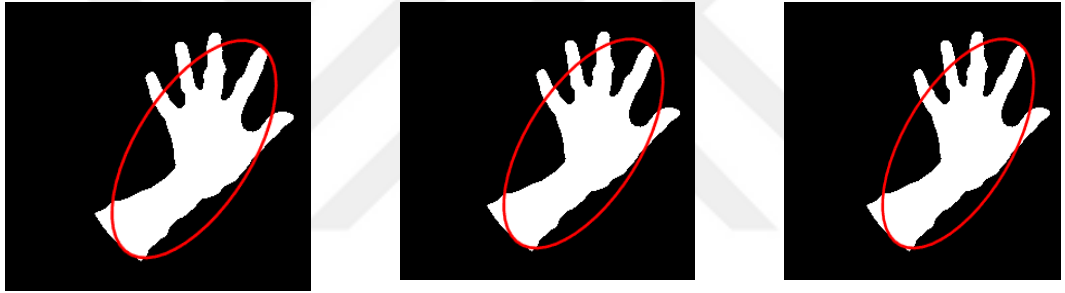
Şekil 4.4. (1) Elips uydurma, (2) Elips eksenlerinin belirlenmesi, (3) EÖU için gerekli olan kenarlar
