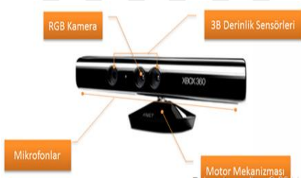
řekil 2.1. Kinect yapısı [15]
