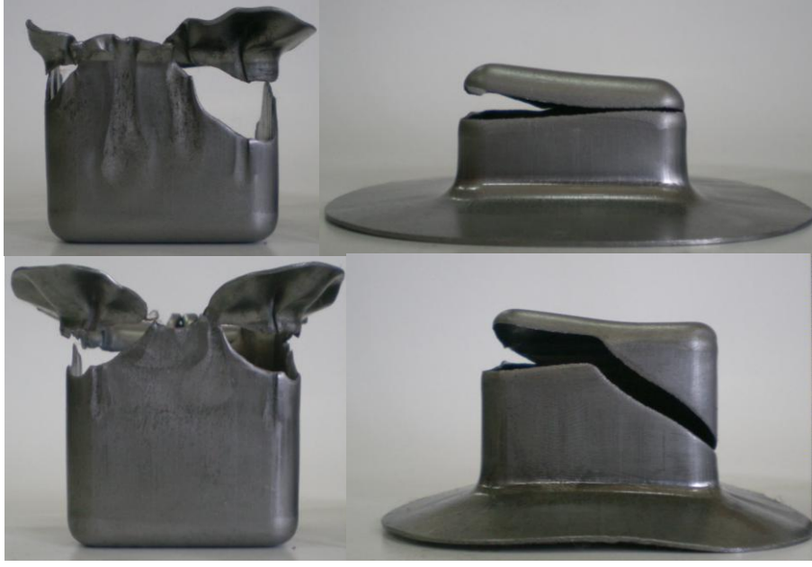
Şekil 5.88. Değişik yırtılma ve çatlak hasarlarının olduğu numuneler
