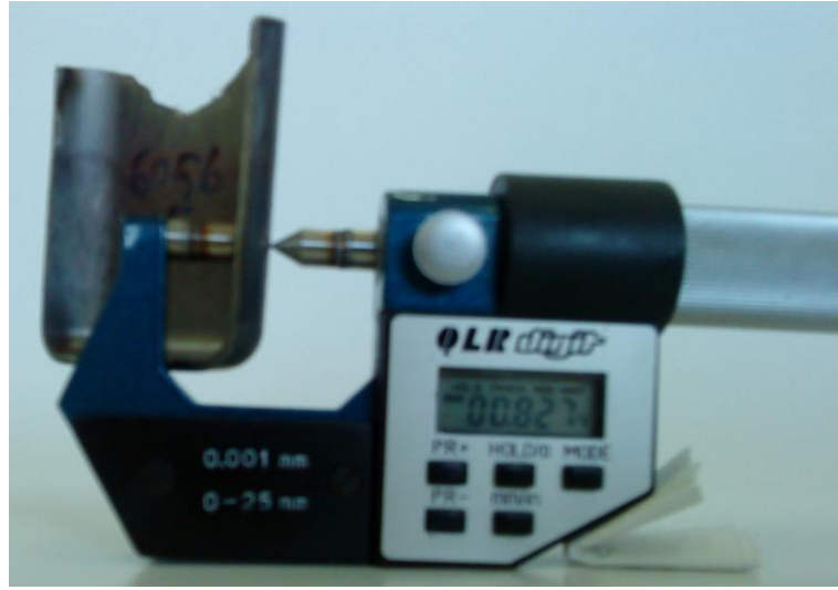
Şekil 5.81. Et kalınlıklarının ölçülmesi
