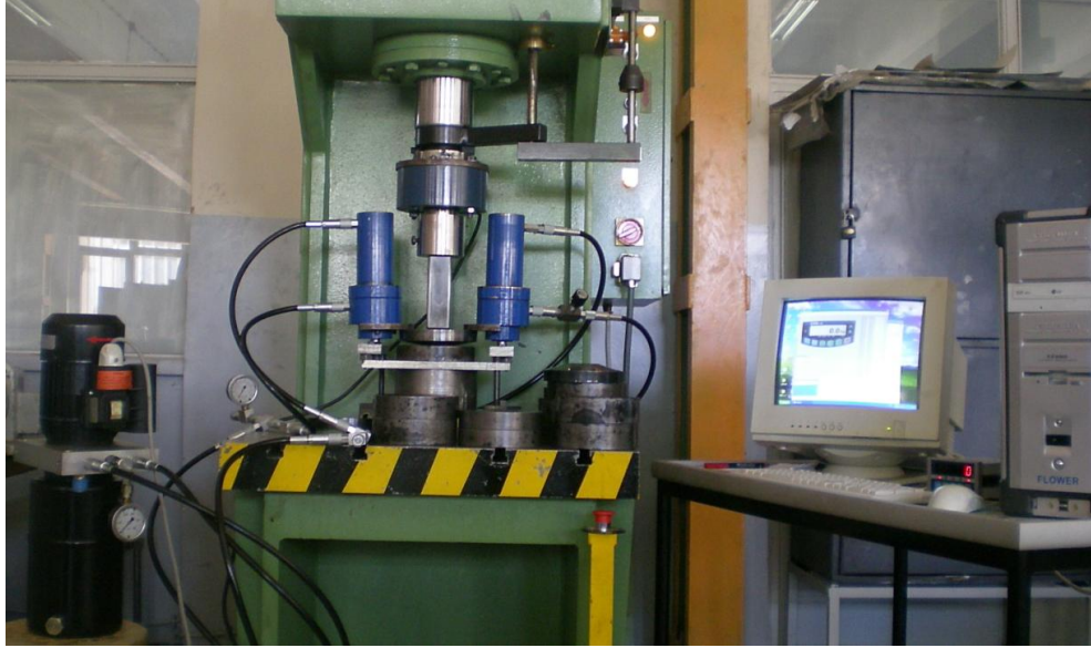
Şekil 4.3. Deneysel çalışmaların yapıldığı pres tezgahı ve kalıp seti
