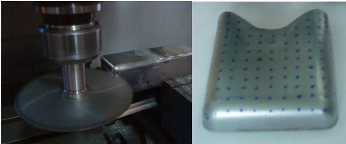
Şekil 5.80. Et kalınlığı ölçümü için hazırlanan numune
