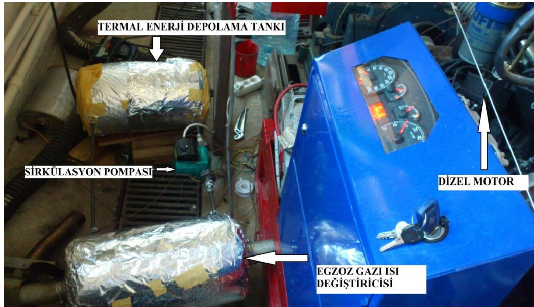
Şekil 4.2. Deney sisteminin üstten görünüşü
