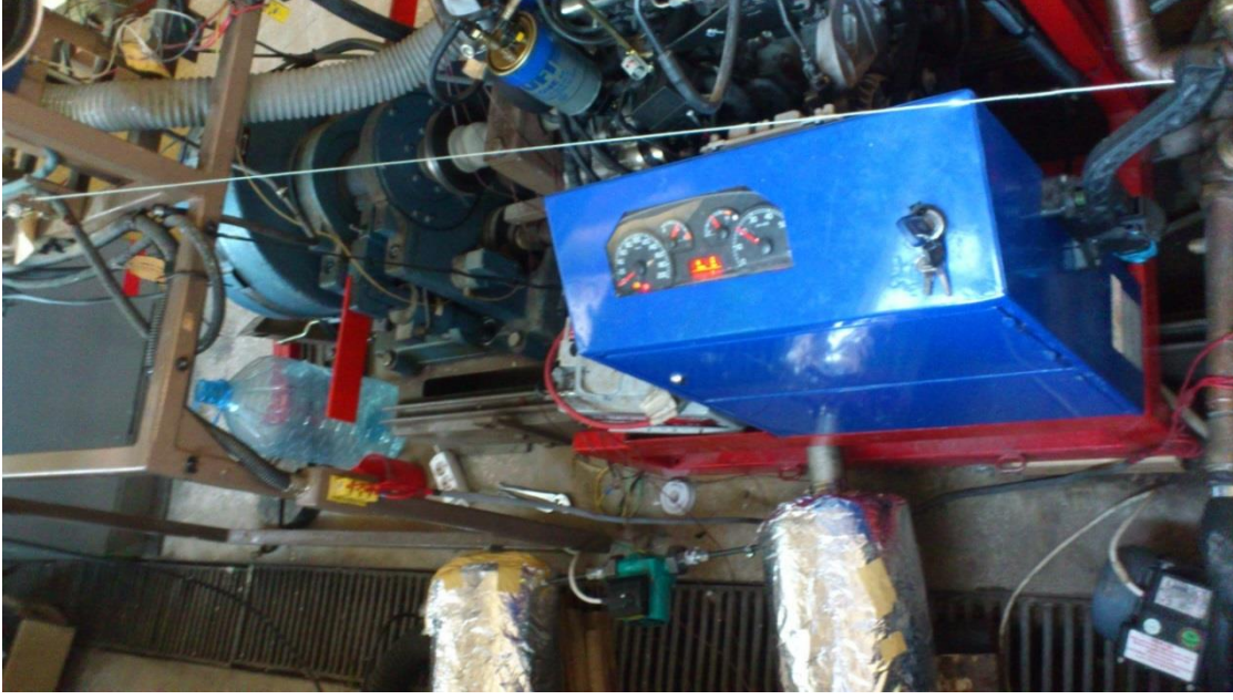
Şekil 4.3. Deney motorunun bremze tezgahına bağlanmış hali
