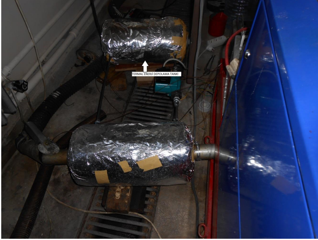
Şekil 4.10. Deney sistemi üzerinde termal enerji depolama tankı
