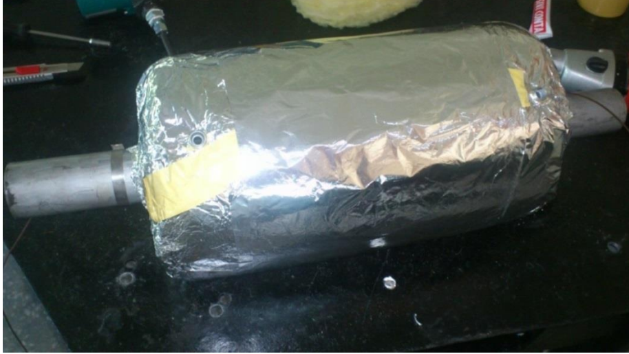
řekil 4.5. Montajı yapılmadan önce egzoz gazı ısı deęiřtiricisi
