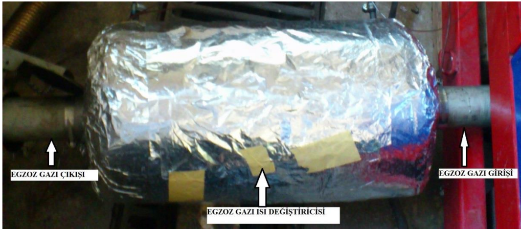
řekil 4.7. Deney motoruna baęlı egzoz gazı ısı deęiřtiricisi.
