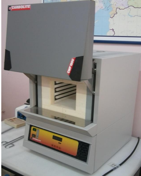
Şekil 7.2. CarboliteC WF-1200 kül fırını.
