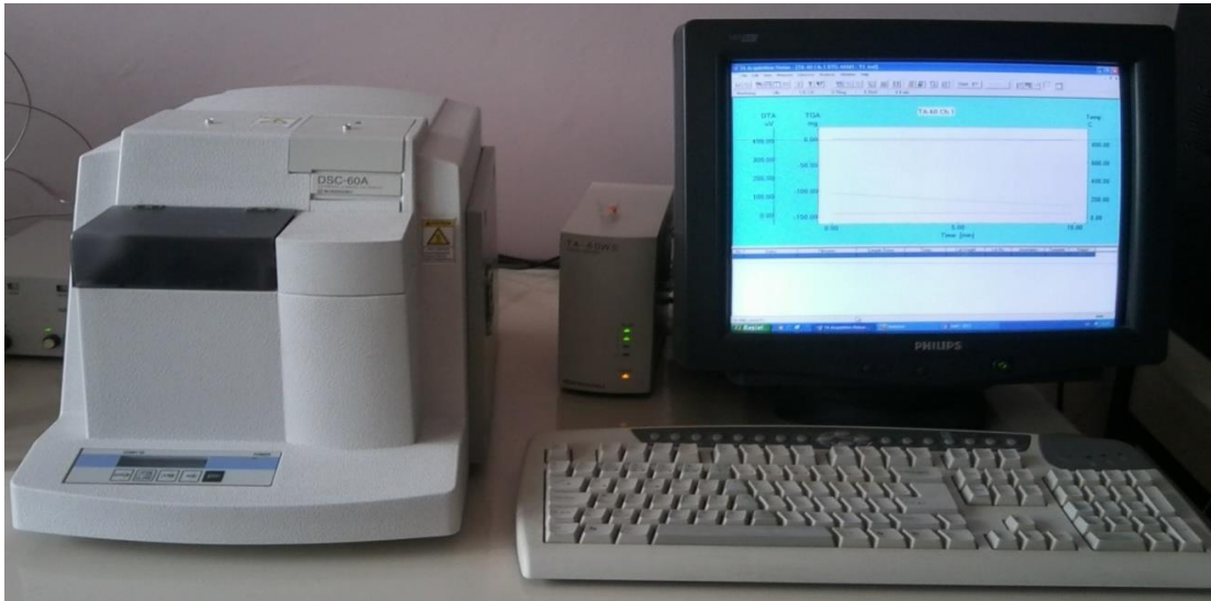
Şekil 7.4. Shimadzu DSC-60A diferansiyel taramalı kalorimetri cihazı.
