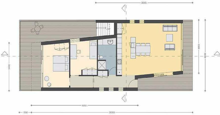
Şekil 2 Aquadomi Danimarka'da yüzen ev tasarımı konsepti ve plan görünüş üzerinden mekansal dağılımlarını gösteren şekil (cfmoller.com).
