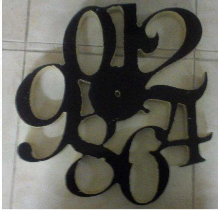
Şekil 6.2. Düz kesimli freze ucu ile kesilmiş Bayburt taşı
