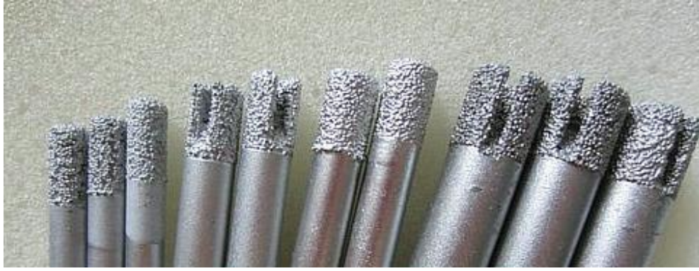
Şekil 6.1. Düz kesim freze uç örnekleri
