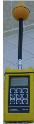
Şekil 4.20. EMR-300 radyasyon metre ve 3-boyutlu alan probu
