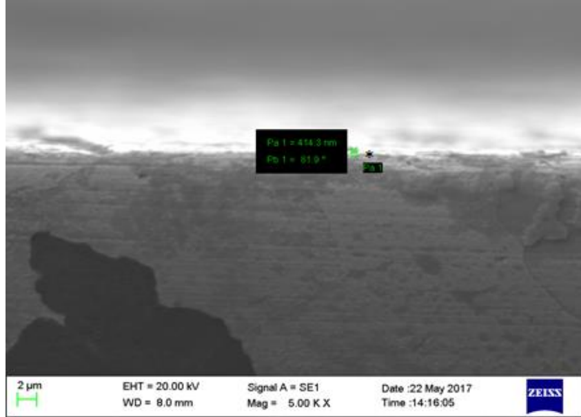
Şekil 5.2. 800 °C 2 Saat Süreyle Kaplanan Numunenin SEM Fotoğrafi
