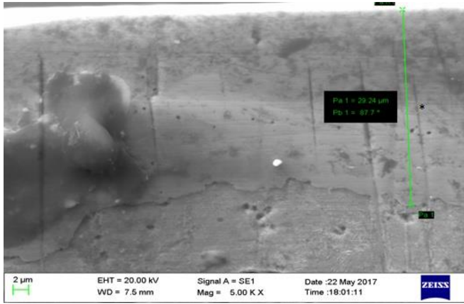
Şekil 5.15.1100 °C 3 Saat Süreyle Kaplanan Numunenin SEM Fotoğrafi
